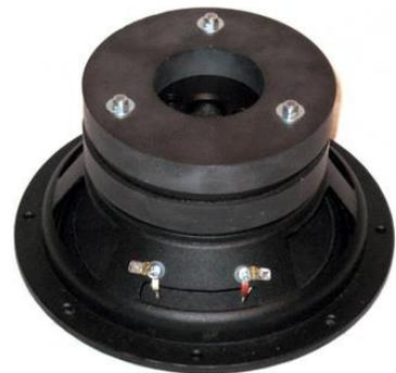
8" (216мм) среднечастотный динамик имеет литой держатель из алюминиевого сплава, тканевый подвес со специальным покрытием, бумажный диффузор, фазовыравнивающее тело «пуля», однослойная звуковая катушка диаметром 51мм намотана плоским проводом на ребро, двойной ферритовый магнит диаметром 135 мм, линейный ход +/-2,5мм.
