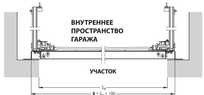
Монтаж за проёмом (горизонтальный разрез) ворот Komfort, Select, Connect.
