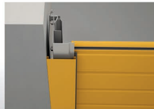
Монтаж в проеме - декоративная панель в проеме
