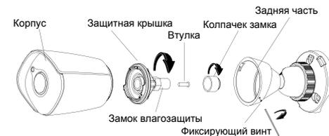
Шаг 1: Выкрутите фиксирующий винт, отсоедините заднюю часть камеры. Снимите колпачек как показано на рисунке, откройте замок, вытащите втулку.
