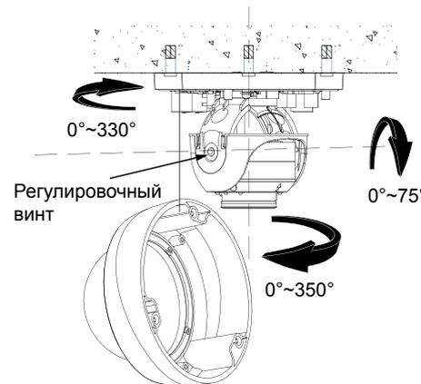
Шаг 4: Ослабьте регулировочный винт, установите необходимый угол обзора используя подсказку на иллюстрации, затяните регулировочный винт.
