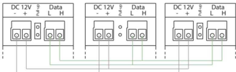
Для подачи питания на блок Relay-4S соедините кабелем\*, соблюдая полярность, клеммы DC 12V двух блоков Relay-M / S.
