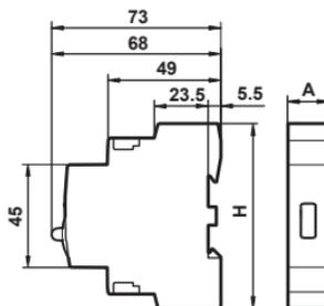
Рис. 1 - Габаритные размеры контакторов КМ РУ
