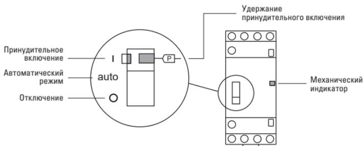
Контактор блокируется в положении «I» на время техобслуживания электроустановки с помощью защелки.
