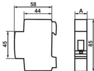
Рис. 1 - Габаритные размеры контакторов КМ
