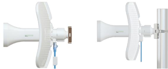
5. Большим и указательным пальцами слегка надавите по обеим боковым сторонам крышки, закрывающей Ethernet разъем на X-кронштейне, и осторожно потяните параллельно вниз. Вставьте UTP-кабель в Ethernet разъем. Установите на место защитную крышку поверх UTP-кабеля.
