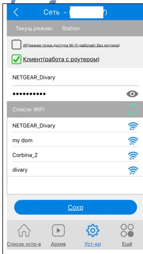
можно изменить параметры беспроводного доступа. Например подключиться к другой WiFi сети. Или ввести Ваше устройство в режим работы точки доступа. В этом случае, у устройства появится своя WiFi сеть. Вы сможете подключиться к устройству напрямую в параметрах настройки WiFi сети Вашего мобильного устройства.
