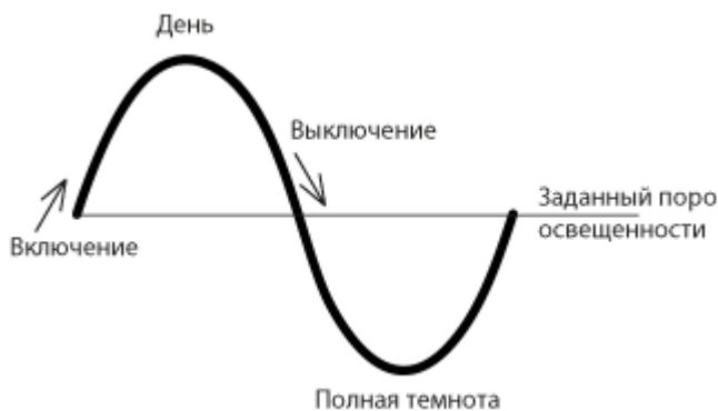
Режим **«День»**. Включить при повышении освещенности выше порога, выключить при снижении освещенности ниже порога. Например для открытия штор с рассветом.
