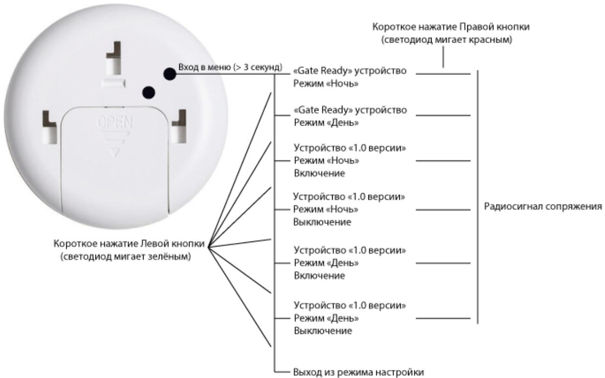
Пример сопряжения датчика движения с устройством «Gate Ready» в режиме «День»:
