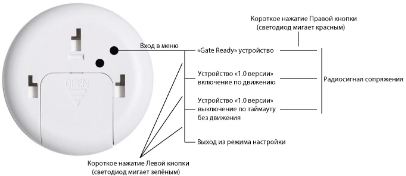
Пример сопряжения датчика движения с устройством «1.0 версии»:
