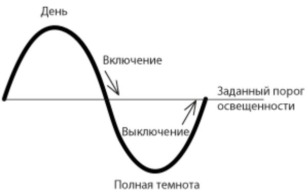
Режим **«Ночь»**. Включить при снижении освещенности ниже порога, выключить при повышении освещенности выше порога. Например для включения уличного освещения при наступлении темноты.
