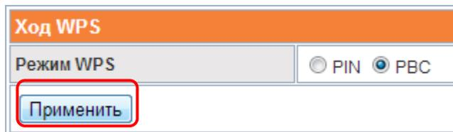
Кнопка WPS на подключаемом устройстве может быть как и физическая (например, на корпусах некоторых Wi-Fi адаптеров), так и программная (в смартфонах и планшетных ПК, как правило, присутствует именно она). Если самостоятельно найти кнопку WPS на корпусе или в меню управления устройства не получается, обратитесь к справочной документации для данного устройства.
