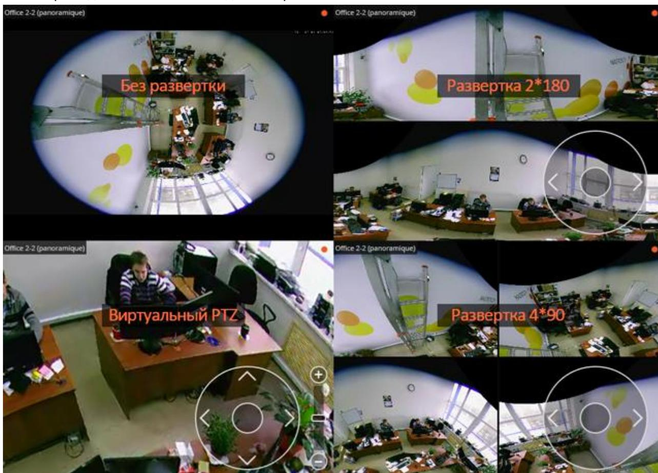
**Без развертки** — изображение в ячейке выводится без преобразования: в том виде, в котором получено от камеры.
