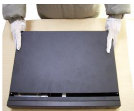
1) Открутите винты, фиксирующие крышку
