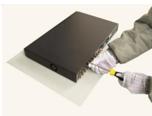
8) Зафиксируйте крышку винтами
