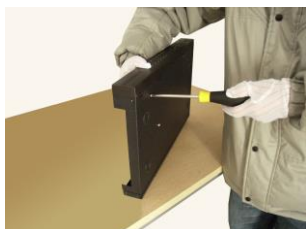
4) Зафиксируйте диск винтами
