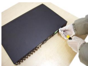
1) Открутите винты, фиксирующие крышку
