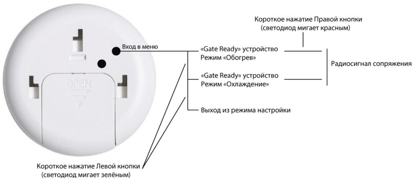
Пример сопряжения датчика температуры с управляемым устройством в режим «обогрев»:
