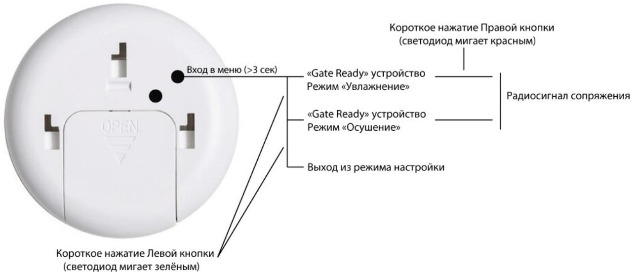
Пример сопряжения датчика влажности с управляемым устройством в режим «осушение»:
