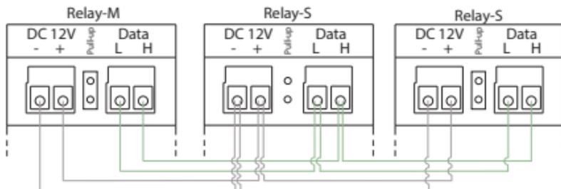
Для подачи питания на блок Relay-4S соедините кабелем\*, соблюдая полярность, клеммы DC 12V двух блоков Relay-M / S.
