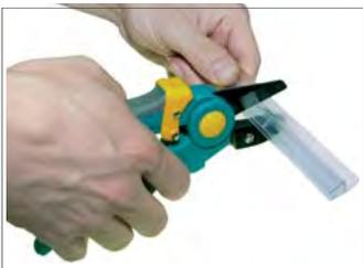
Арт. К.6001 Ножницы для обрезки уплотнителя
