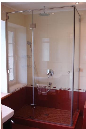
При изготовлении душевых кабин используется закалённое стекло толщиной 8–10 мм и фурнитура ORMAN. Для предотвращения попадания воды на пол применяется уплотнитель ПВХ профиль. Петли имеют механизм доводки дверей. Душевые кабины из стекла экономят пространство в ванной комнате и придают визуальную воздушность и утончённость.
