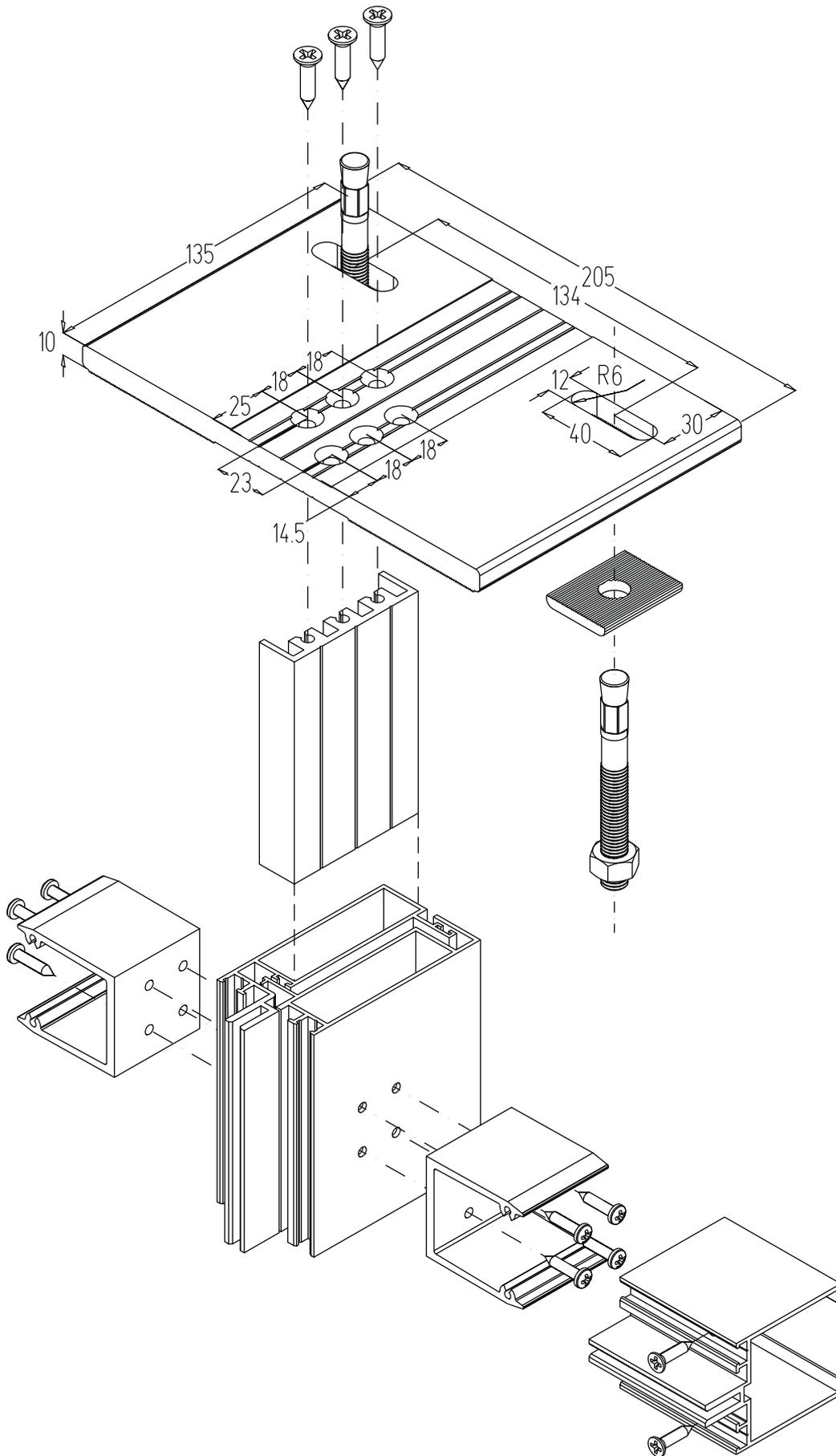
**Нижний узел крепления компенсационной стойки
