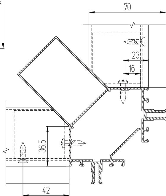
**Примечание:** закладные ригелей крепятся к стойке КП45562 только по схеме с двумя винтами. Остальные схемы крепления не применяются.
