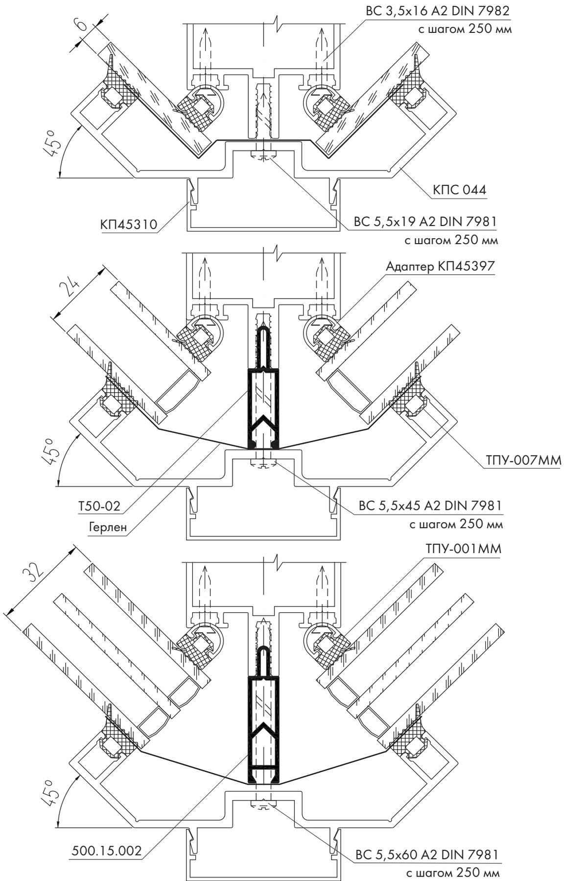
**Внешний поворот витража со стеклом 6 мм, стеклопакетом 24 и 32 мм на угол от 190° до 210° через одну стойку с использованием держателя КПС 286 и крышки КП45326-1**
