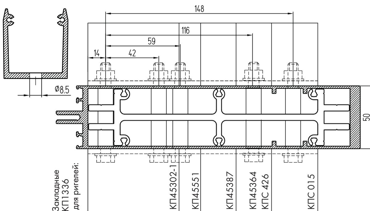
**Примечание:** на схемах следует выбирать из общего количества болты и винты, применимые к размеру необходимой закладной и к выбранной схеме крепления.
