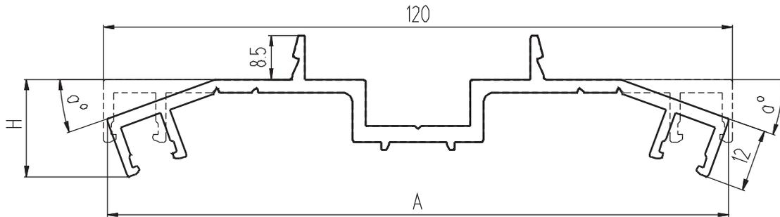
Схема гібки профіля КП45354 для заполнения 6, 24, 32 мм
