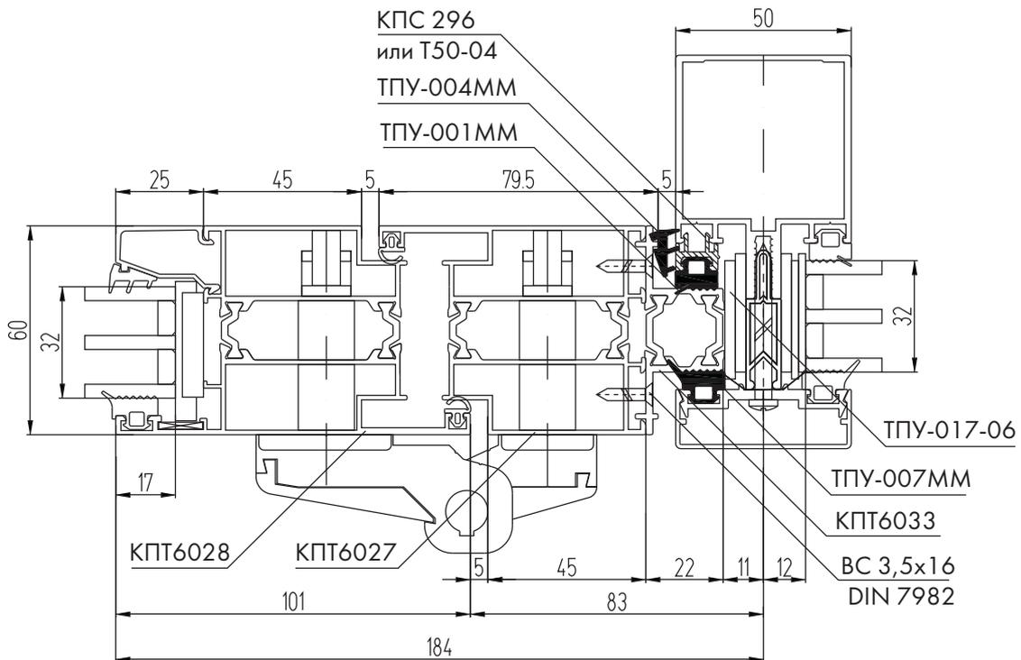
Установка "теплой" двери КРТ60 с петлями на клеммах
