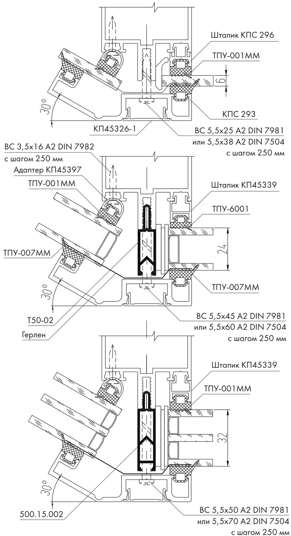
**Внешний поворот витража со стеклом 6 мм, стеклопакетом 24 и 32 мм на угол от 240° до 255° через одну стойку с использованием держателя КПС 289 и крышки КП45326-1**
