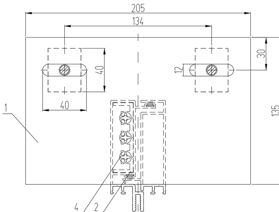
Верхний узел крепления компенсационной стойки
