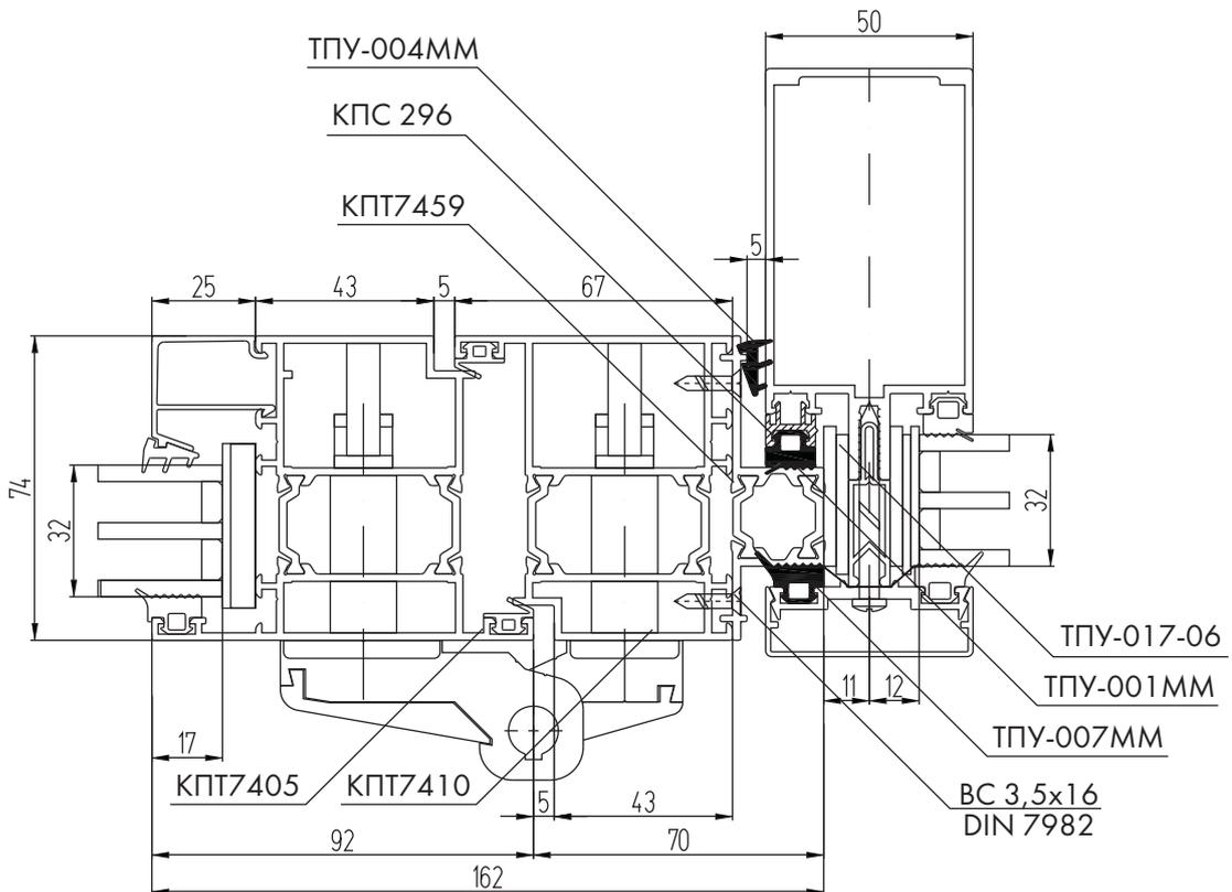
Установка "теплых" бесшпильковых дверей КПТ60 и КПТ74
