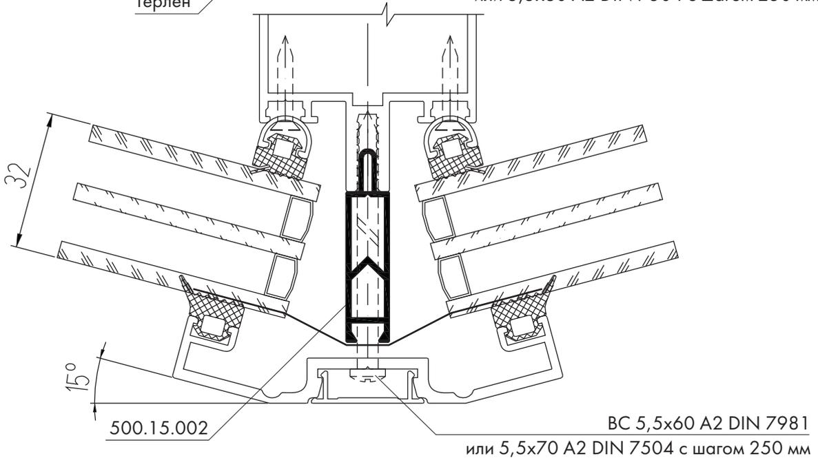
**Внешний поворот витража со стеклом 6 мм, стеклопакетом 24 и 32 мм на одну сторону на угол от 5° до 15° через одну стойку с использованием держателя КПС 291 и крышки КП45326-1**
