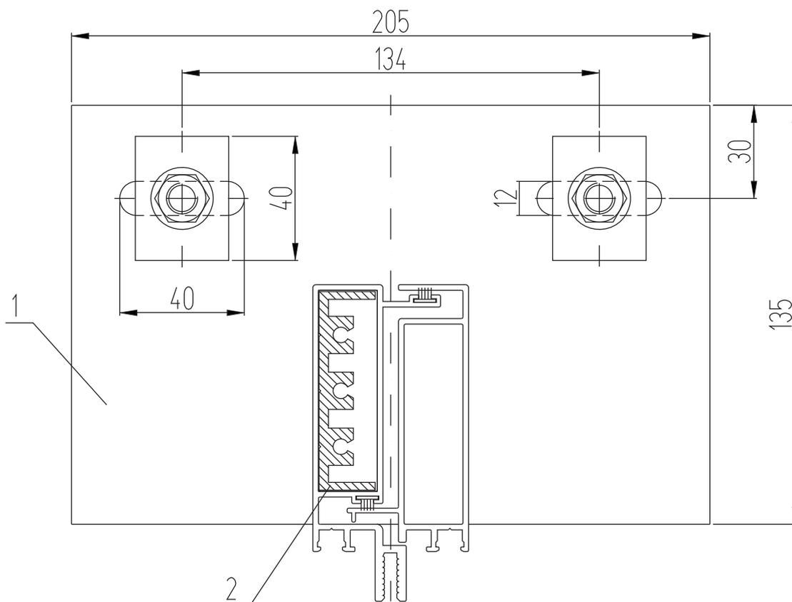
Нижний узел крепления компенсационной стойки
