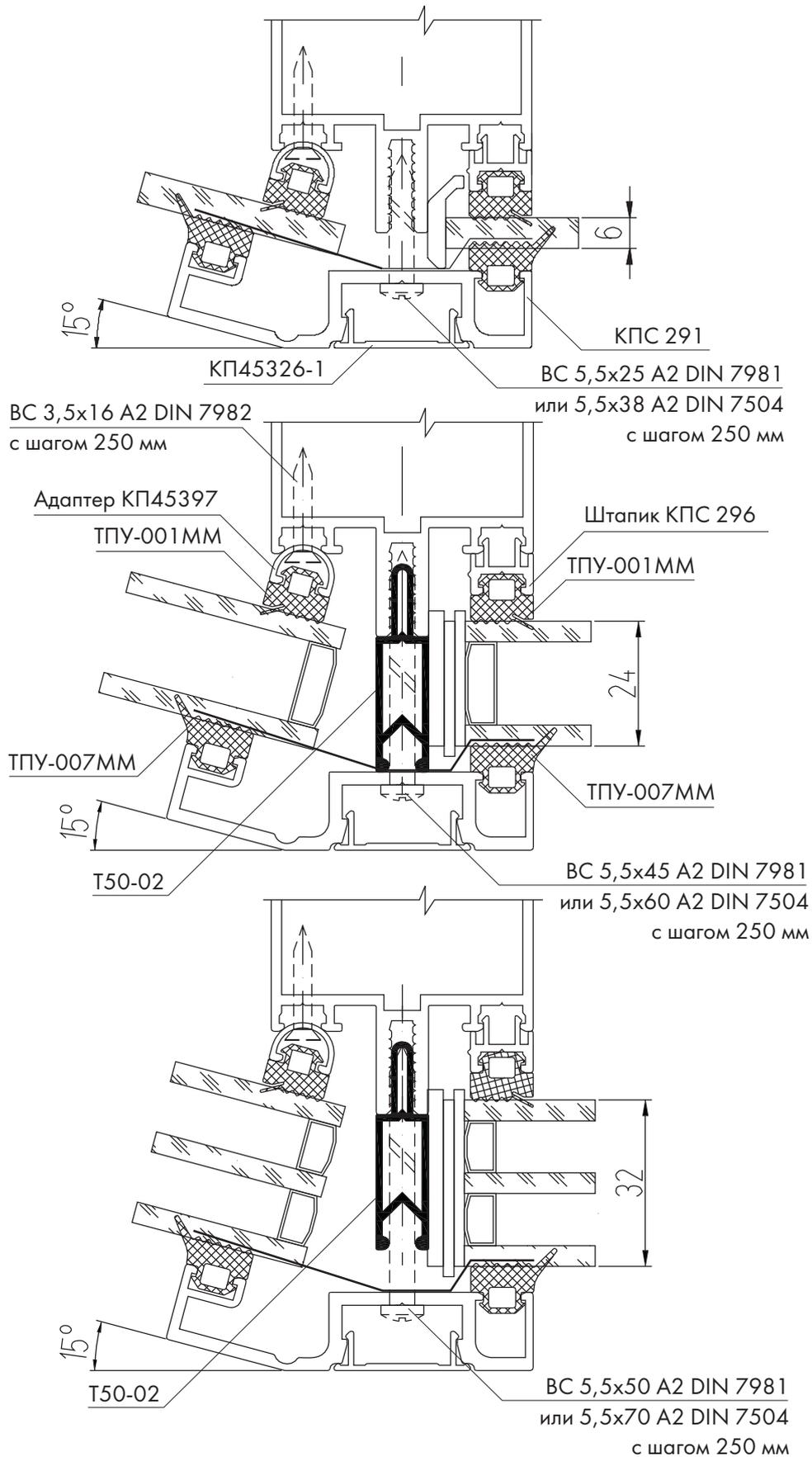
**Внешний поворот витража со стеклом 6 мм, стеклопакетом 24 и 32 мм на угол от 210° до 225° через одну стойку с использованием держателя КПС 287 и крышки КП45326-1**
