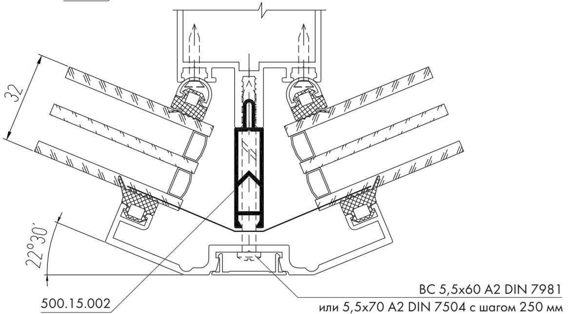
**Внешний поворот витража со стеклом 6 мм, стеклопакетом 24 и 32 мм на одну сторону на угол от 15° до 22,5° через одну стойку с использованием держателя КПС 292 и крышки КП45326-1**
