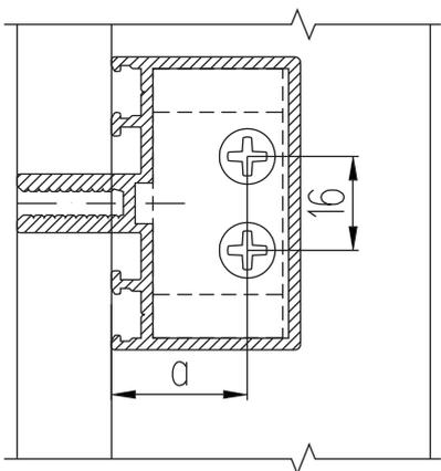
Узел крепления двумя винтами
