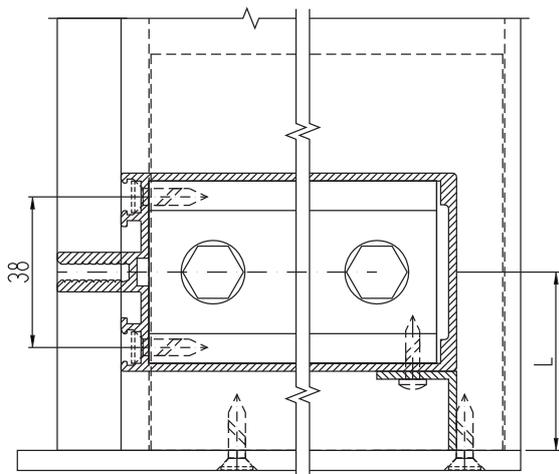
Узел крепления двумя болтами
