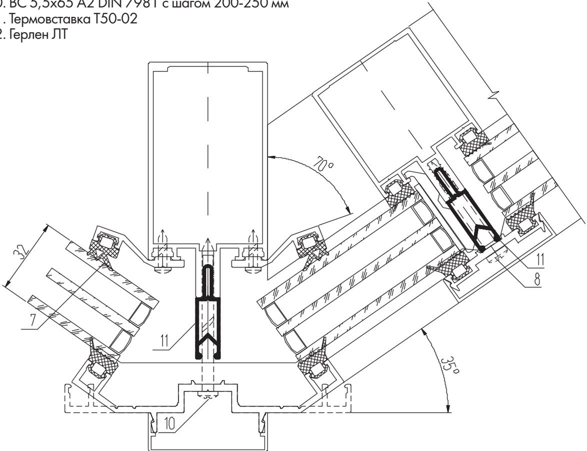
Внешний поворот витража со стеклом 6 мм, стеклопакетом 24 и 32 мм на угол 90° через одну стойку с использованием держателя КПС 044 и крышки КП45310
