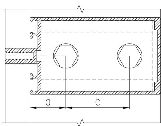
Узел крепления двумя болтами
