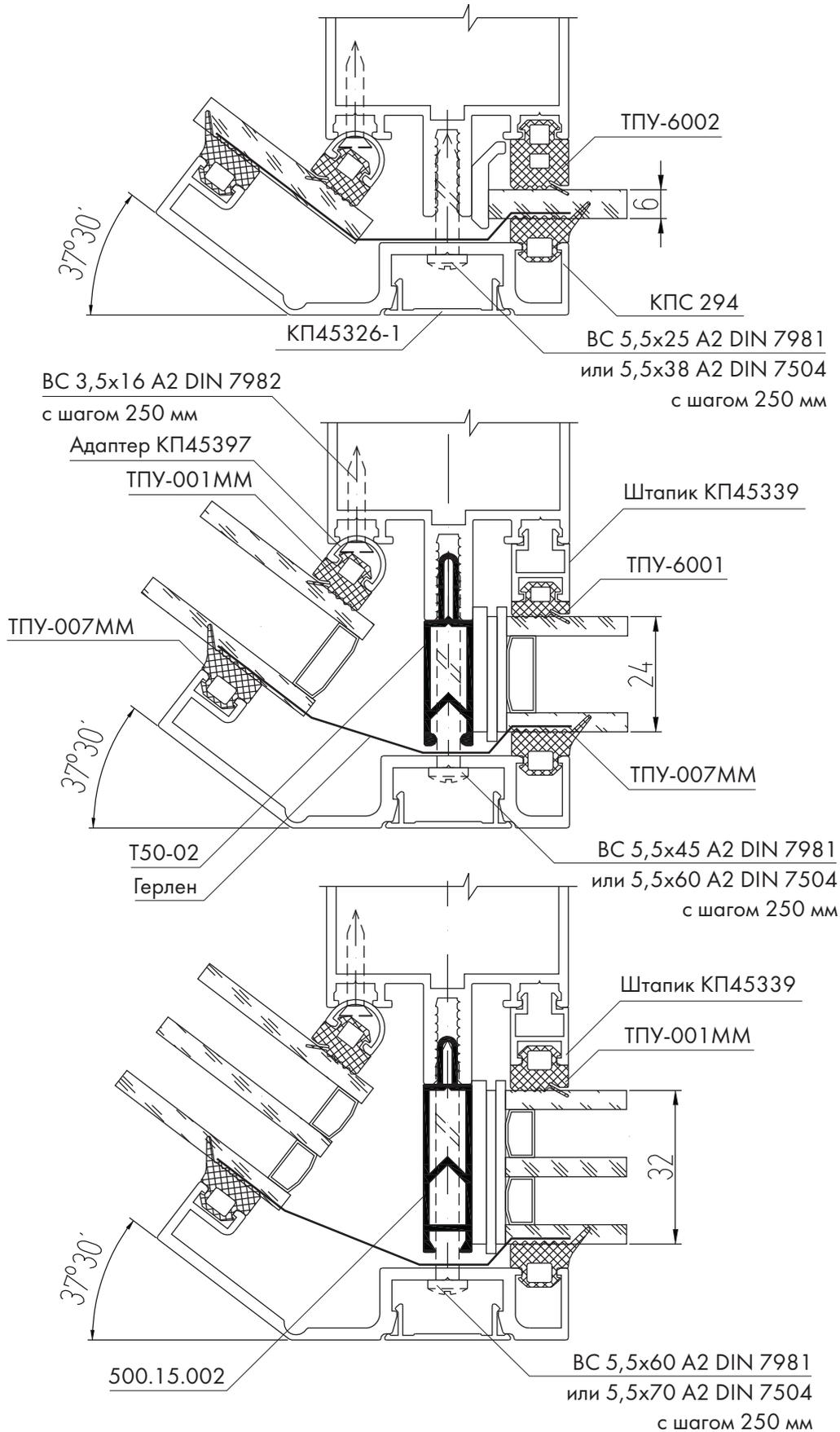
**Внешний поворот витража со стеклом 6 мм, стеклопакетом 24 и 32 мм на угол от 255° до 270° через одну стойку с использованием держателя КПС 290 и крышки КП45326-1**
