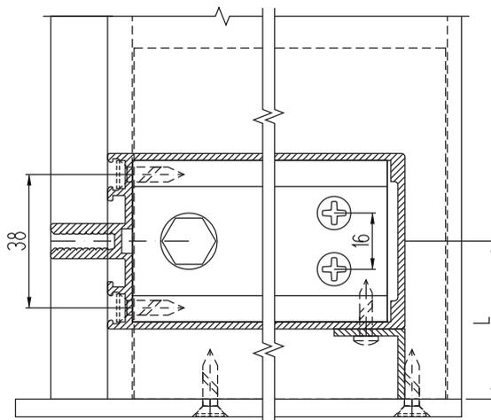
Узел крепления болтом M8x75 DIN 931 A2
