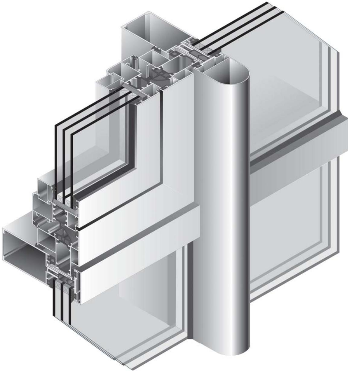
Промежуточное крепление ригелей КР45302-1 к стойке КР45302-1 с крышками КР45309 на ригелях и КР45315 на стойке, крепление "теплой" створки с двухкамерным стеклопакетом в витраж
