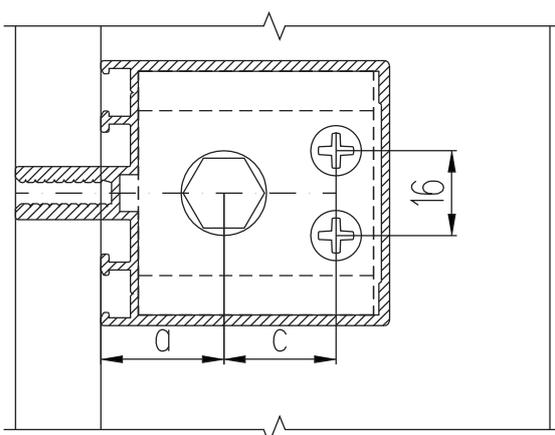
Узел крепления болтом M8x75 DIN 931 A2
