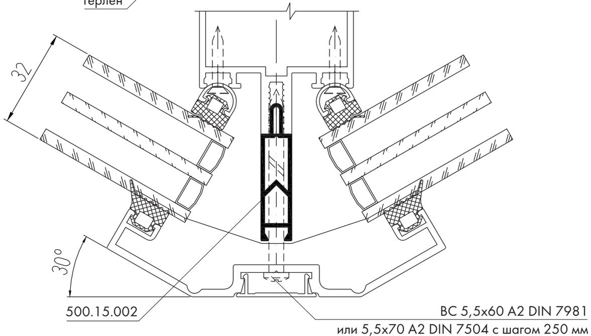
**Внешний поворот витража со стеклом 6 мм, стеклопакетом 24 и 32 мм на одну сторону на угол от 22,5° до 30° через одну стойку с использованием держателя КПС 293 и крышки КП45326-1**
