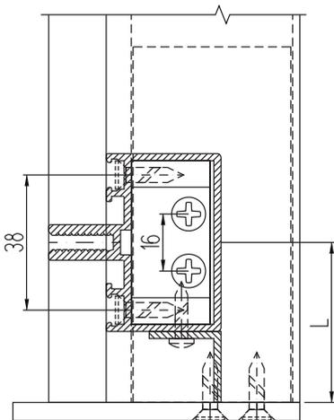
Узел крепления двумя винтами
