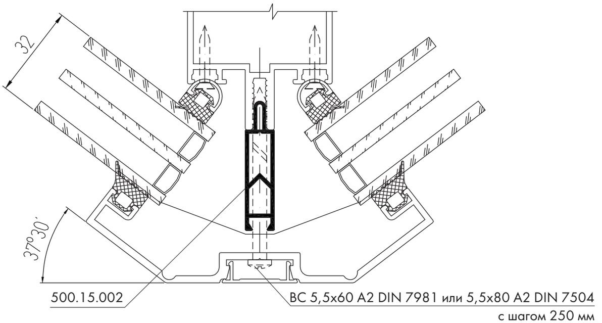
**Внешний поворот витража со стеклом 6 мм, стеклопакетом 24 и 32 мм на одну сторону на угол от 30° до 37,5° через одну стойку с использованием держателя КПС 294 и крышки КП45326-1**
