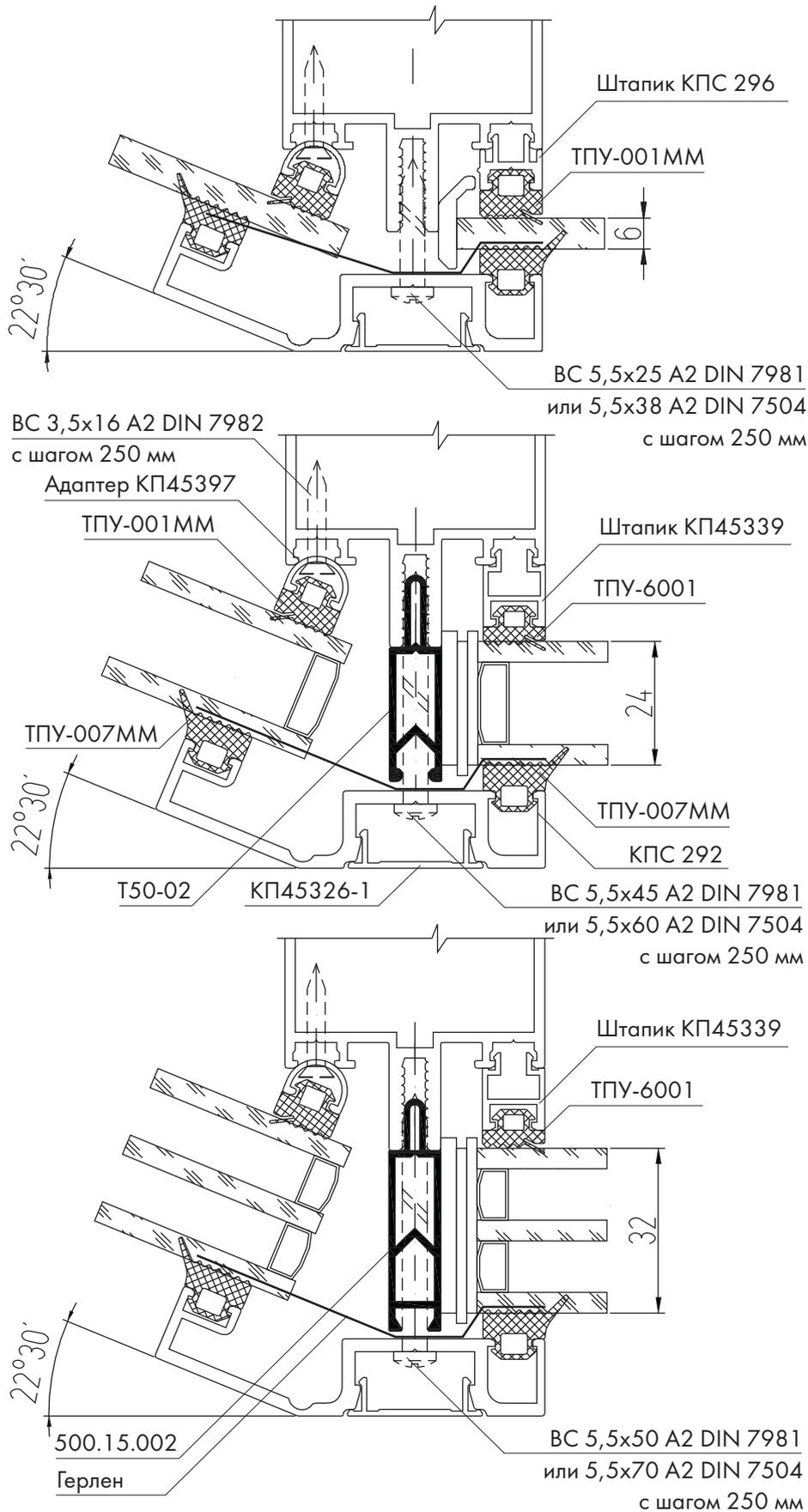
Внешний поворот витража со стеклом 6 мм, стеклопакетом 24 и 32 мм на угол от 225° до 240° через одну стойку с использованием держателя КПС 288 и крышки КП45326-1
