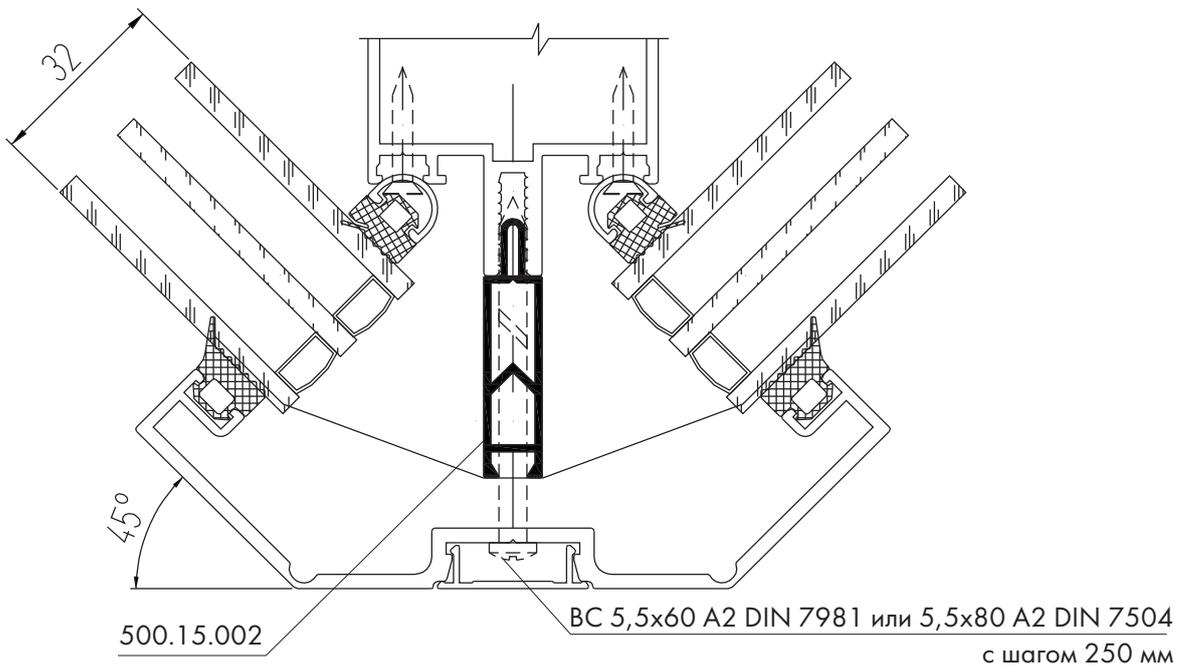
**Внешний поворот витража со стеклом 6 мм, стеклопакетом 24 и 32 мм на одну сторону на угол от 37,5° до 45° через одну стойку с использованием держателя КПС 295 и крышки КП45326-1**
