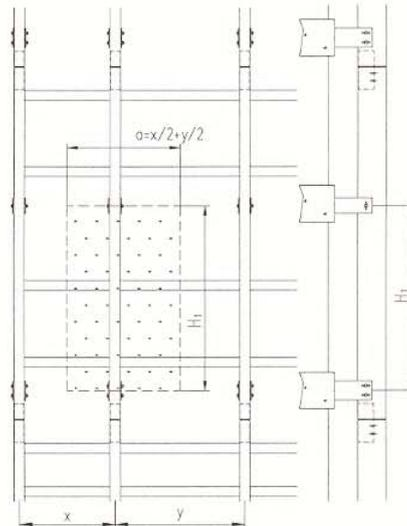
Здание расположено в районе, соответствующему типу местности B. Учитывая тип местности и высоту на которой находится витраж- 30 м, выбираем значение k(z<sub>e</sub>)= 0,975
