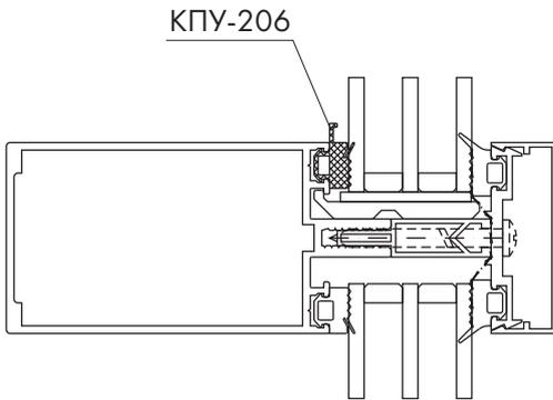
Подрезка уплотнителя КПУ-206
