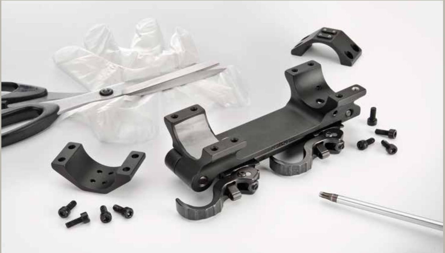
Eine Alternative zum Verkleben des Zielfernrohres in den Montageringen ist das Einlegen von zurechtgeschnittenen Streifen aus dünnen Latex-Einmalhandschuhen, wie sie im medizinischen Bereich verwendet werden. Mit dieser Methode wird eine sehr gute Haftung erreicht.
