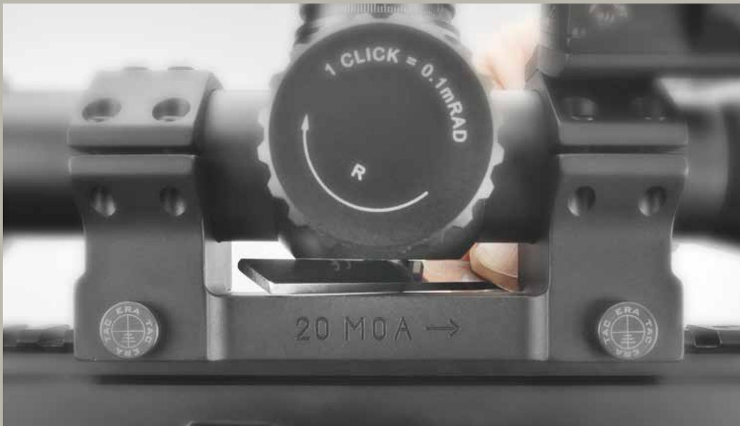
Zielfernrohre, die mittels einer Blockmontage oder aber mit Einzelringen auf einer Picatinny-Schiene montiert werden, lassen sich schnell und einfach mit Hilfe eines Bleches ausrichten.
