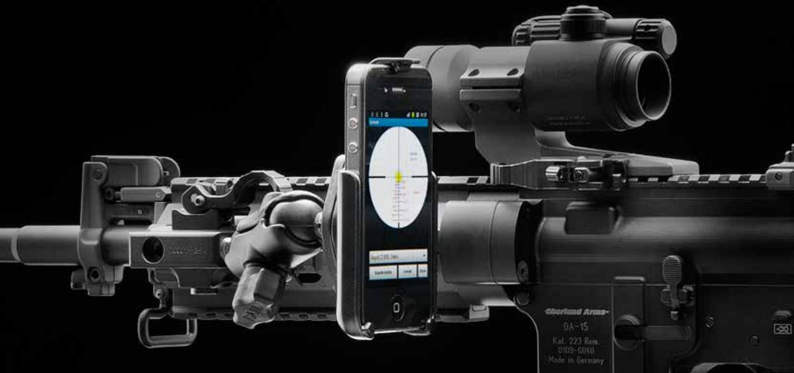
Das iPhone bietet dem ambitionierten Schützen ungeahnte Möglichkeiten wie z.B. das Erstellen von Fotos, die Dokumentation von Trainingseinheiten als Film oder den Einsatz als elektronische Libelle zur Vermeidung von Verkantungsfehlern sowie die Nutzung eines immer größer werdenden Angebots an ballistischen Apps.
