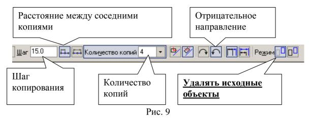
На запрос системы Укажите базовую точку выделенных объектов укажите центр выделенной окружности (базовый объект), на запрос системы Укажите направляющую кривую для копирования объектов курсором укажите прямую, на которой будут располагаться окружности (вертикальная центровая линия), рис. 10, на запрос системы Укажите начальную точку на кривой укажите центр выделенной окружности (начальная точка на кривой). Прервите команду и обновите изображение [Ctrl+F9].
