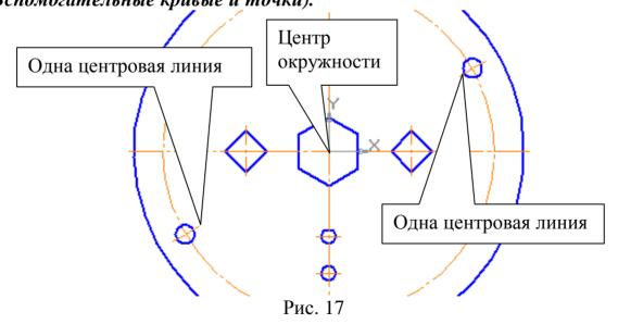
Проставьте одну центровую линию на каждой окружности. Для этого: *Обозначения* **№** – *Обозначение центра* • – *Одна ось*. Укажите курсором окружность, а затем начало координат, рис. 17.
