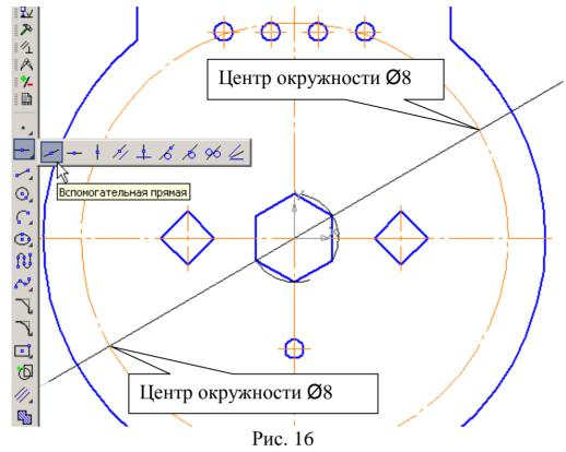
В строке параметров проставьте угол  $30^{\circ}$  и укажите курсором начало координат, рис. 16.
