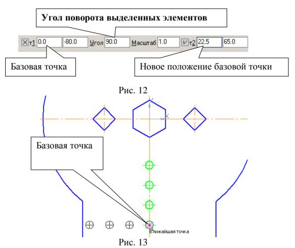
На запрос системы *Укажите новое положение базовой точки* в строке параметров (т2) введите координаты (22,5; 65), рис. 7. Изображение пластины после копирования показано на рис. 14.
