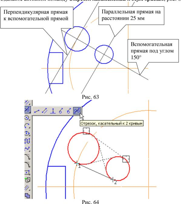
Укажите последовательно курсором окружности и Система создаст четыре варианта отрезка, удовлетворяющих заданным условиям. Нижний вариант будет отображаться сплошной линией, то есть будет текущим. Три остальных - штриховой линией, то есть будут дополнительными. Щелчком на кнопке
