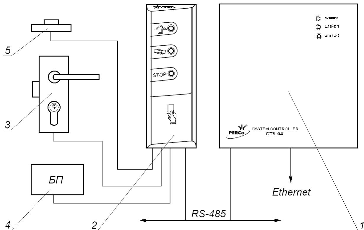
Рисунок 1. Функциональная схема
