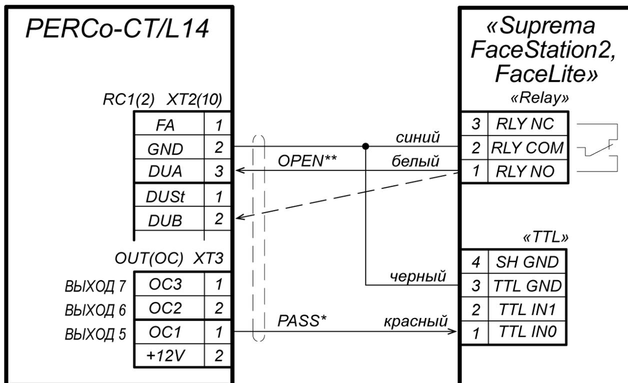
\* - для сигнала PASS может быть использован любой свободный выход контроллера СТ/L14 (тип выхода - «Обычный»), для него в Web-интерфейсе необходимо задать внутреннюю реакцию:
