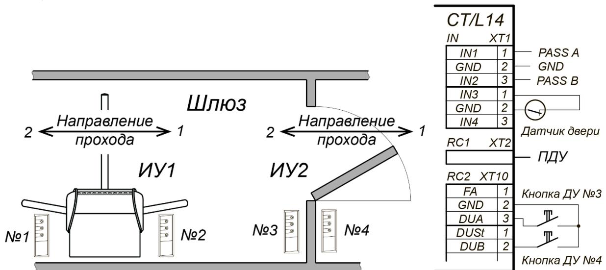
Рисунок 25. Схема шлюза из турникета и замка
