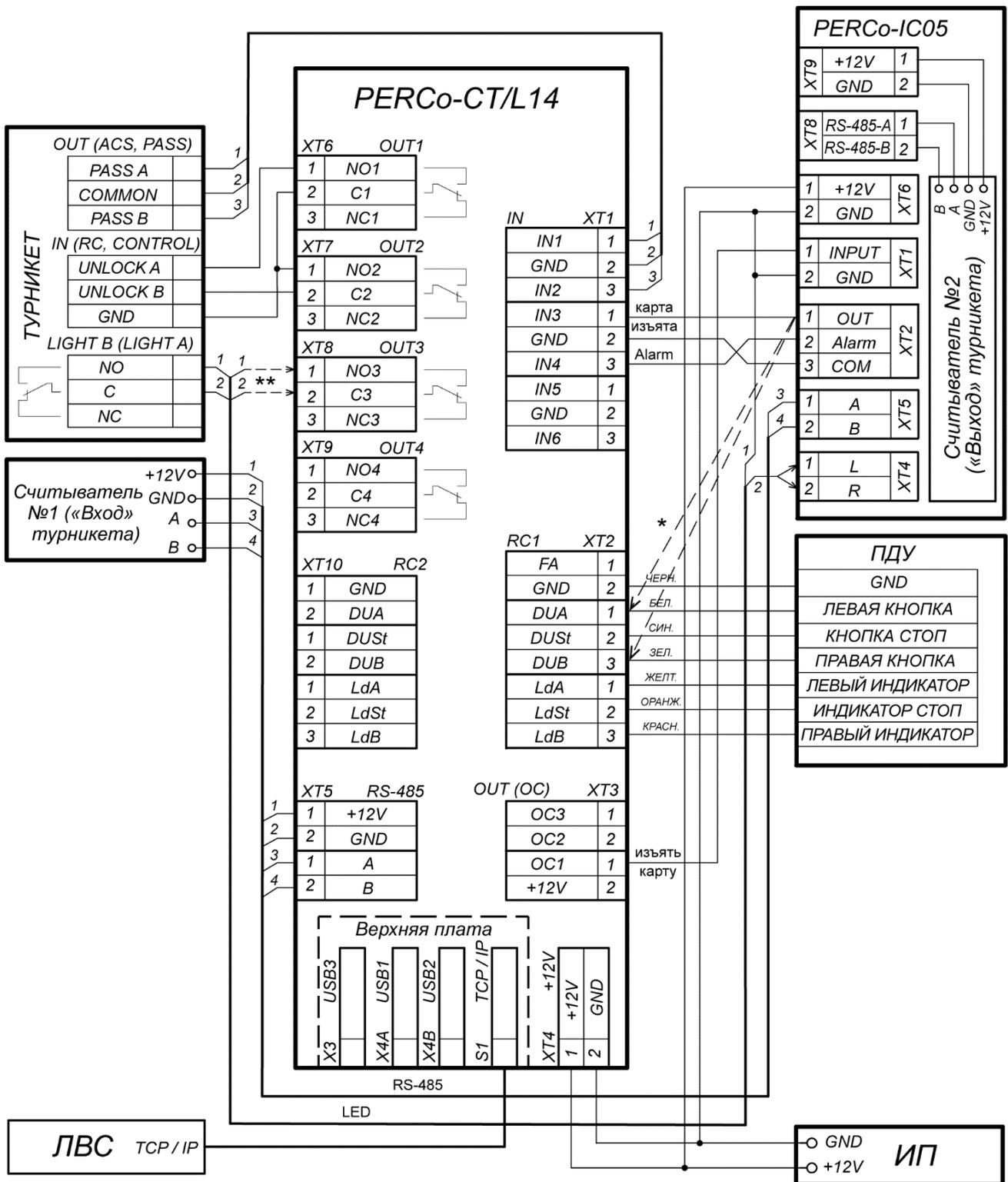
Рисунок 17. Схема подключения картоприемника PERCo-IC05
