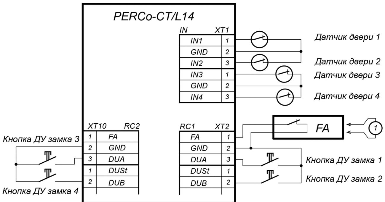
① – провод-перемычка, устанавливается при отсутствии устройства FA
