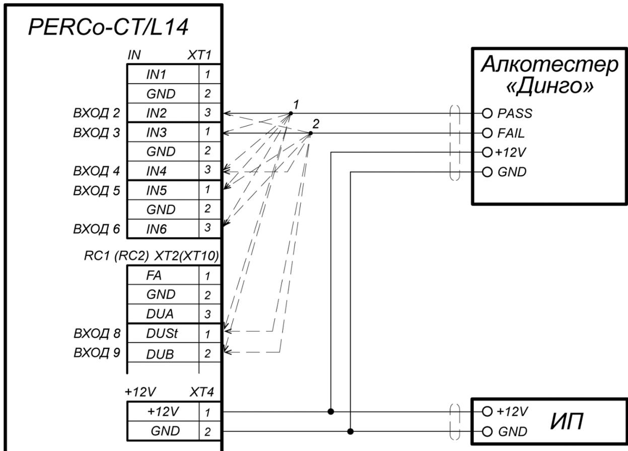
1, 2 - для подключения алкотестера используются два **разных** входа контроллера из любых свободных.
