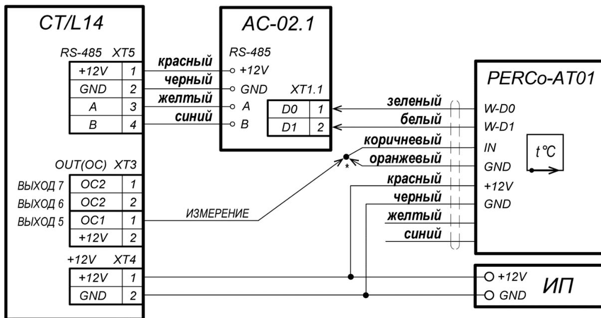
\* - при неиспользовании сигнала ИЗМЕРЕНИЕ для управления пирометром - соедините между собой коричневый и оранжевый провода, измерение температуры при этом будет проводиться постоянно.
