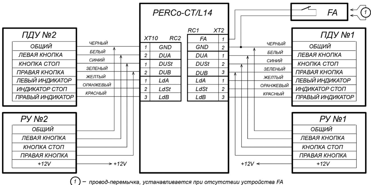
① – провод-перемычка, устанавливается при отсутствии устройства FA
