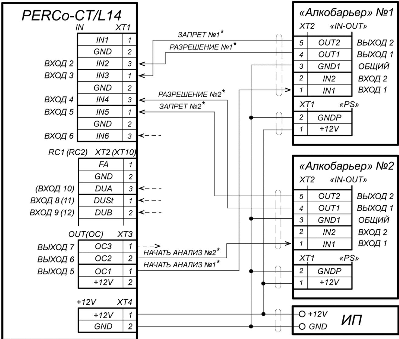
\* - для подключения выходов алкотестеров РАЗРЕШЕНИЕ и ЗАПРЕТ используются 4 разных входа контроллера из любых свободных, для сигнала НАЧАТЬ АНАЛИЗ используется любой свободный выход контроллера.
