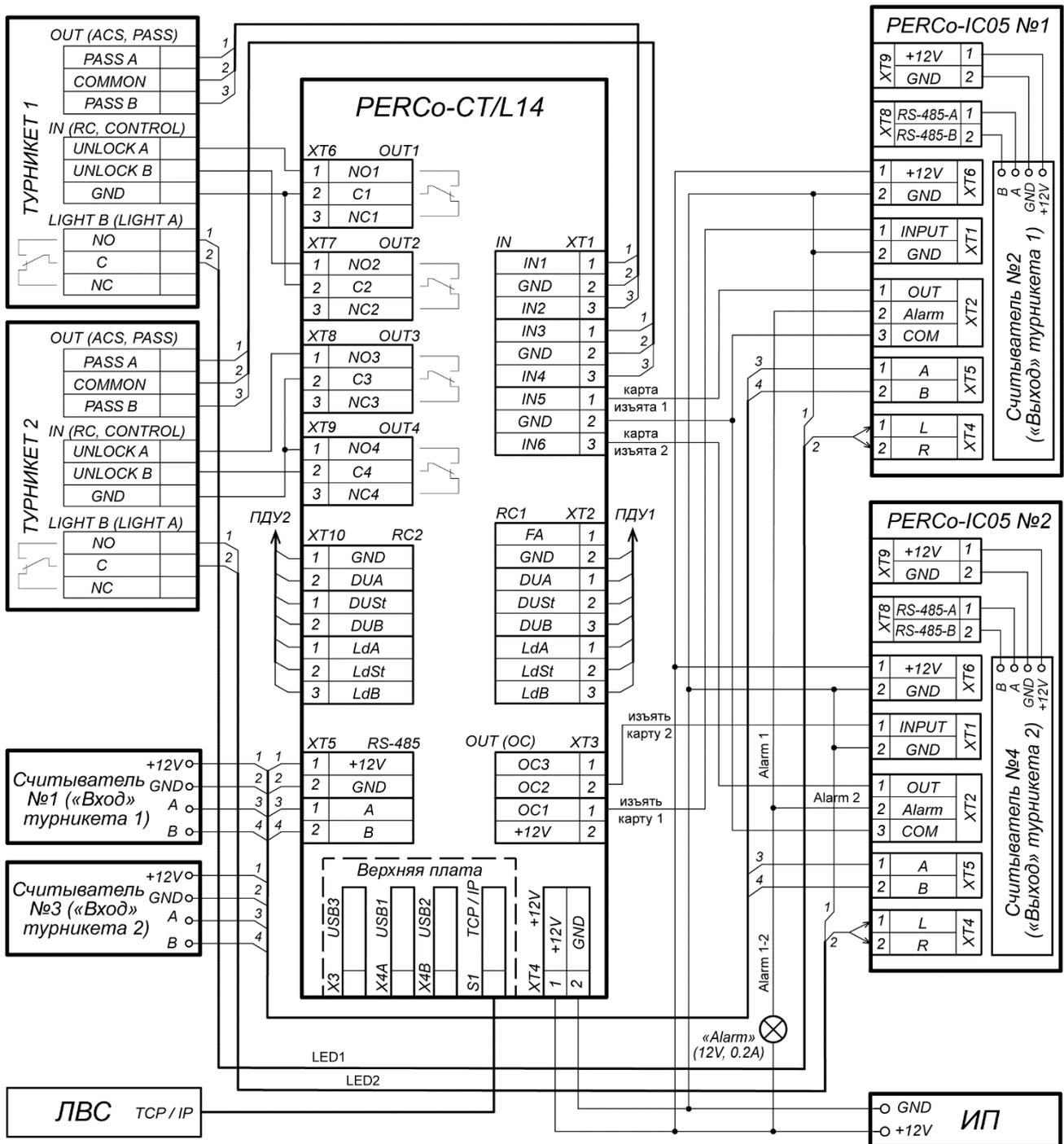
Рисунок 18. Схема подключения двух турникетов с картоприемниками PERCo-IC05
