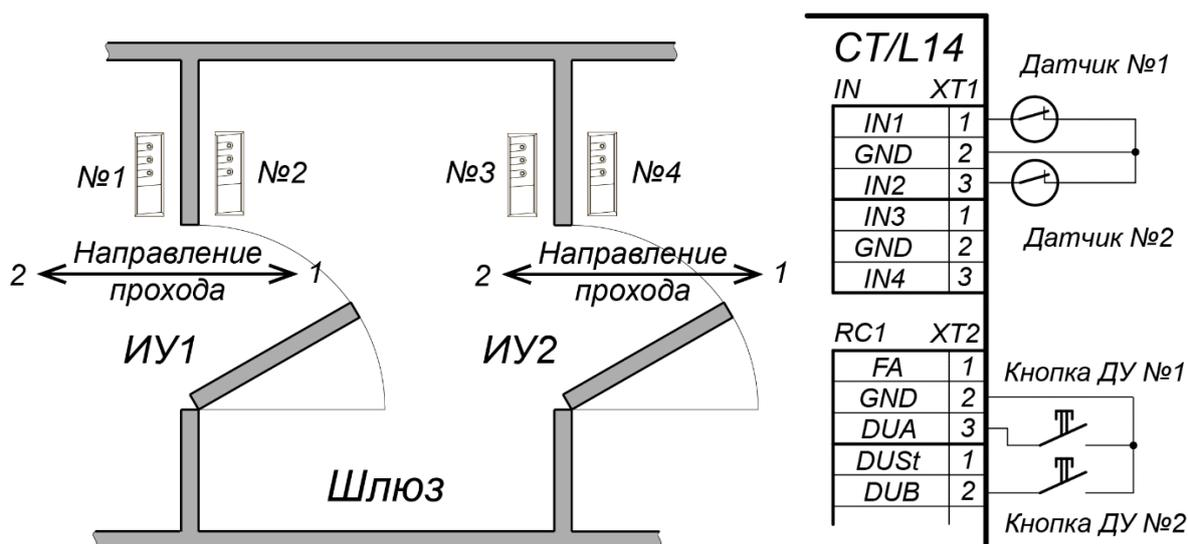
Рисунок 23. Схема шлюза из замков
