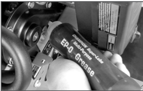
Рис. 22 Добавление смазки в редуктор
