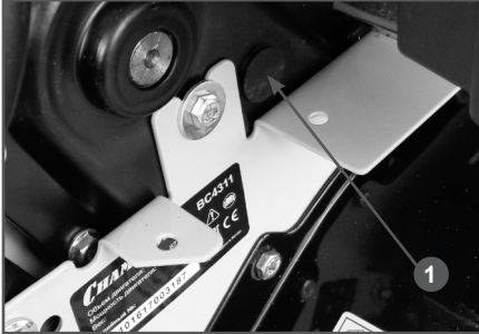
Рис. 21 Расположение пробки отверстия для добавления смазки в редуктор
