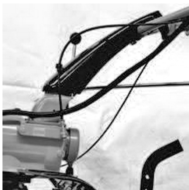
Шаг 7. Соедините все рукоятки органов управления с соответствующими рычагами управляемых механизмов, соответствующими тросами-боденами.
