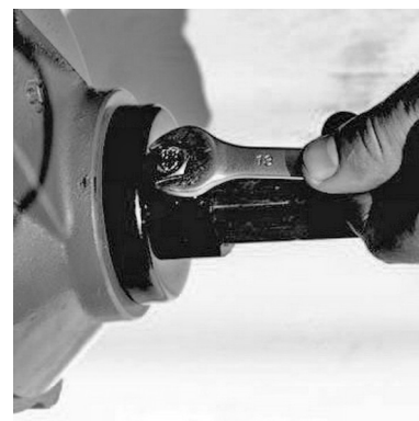
Шаг 3. Закрепить пыльники фиксирующими болтами
