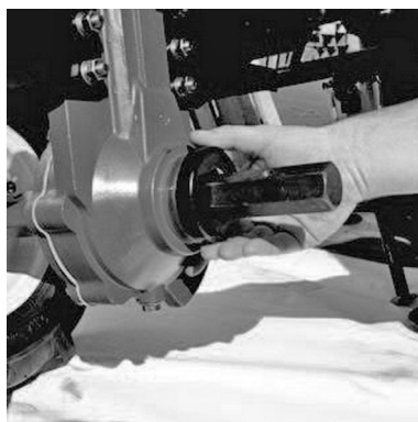
Шаг 2. Установить пыльники с обеих сторон на выходной вал редуктора
