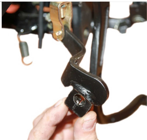
3.12.3. Устанавливаем механизм привода заднего тормоза.
