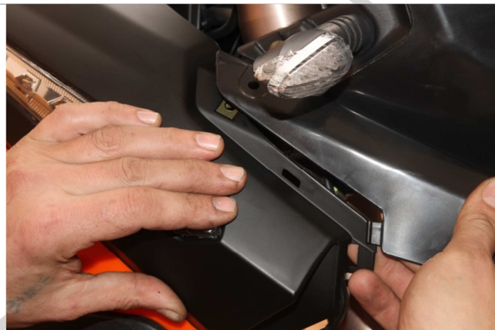
3.14.6. Стыкуем боковой пластик бака с «фальш» крылом переднего крыла.
