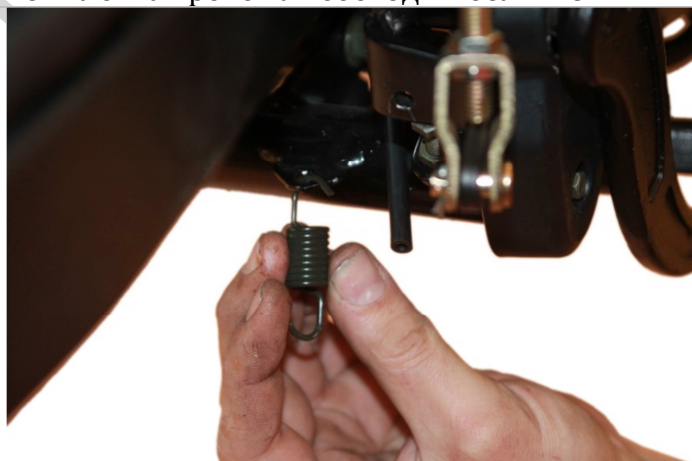
3.12.8. Устанавливаем пружину педали тормоза (в нижней точке крепления данная пружина установлена на заводе).
