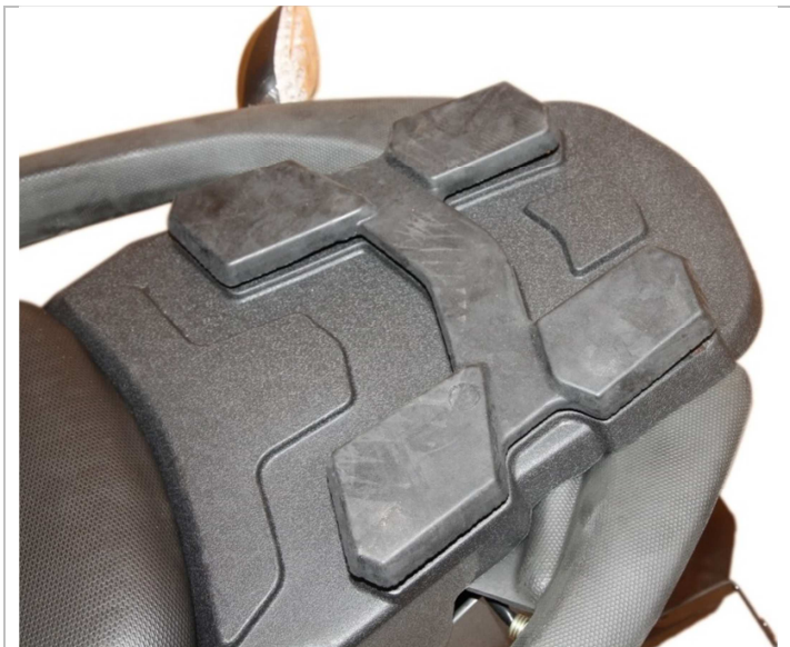
3.23.3. Устанавливаем декоративную накладку на багажник.
