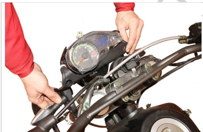
3.6.1. Устанавливаем пластиковый блок с указателями поворотов так, как указано на рисунке.
