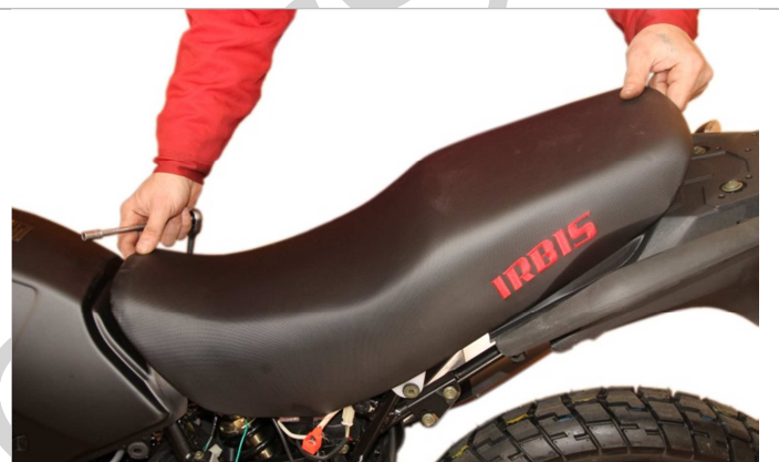
3.13.2. Потянув сиденье назад, снимаем его.
