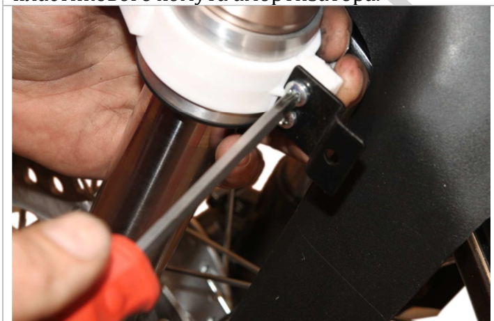
3.20.3. Фиксируем ранее выкрученными винтами.
