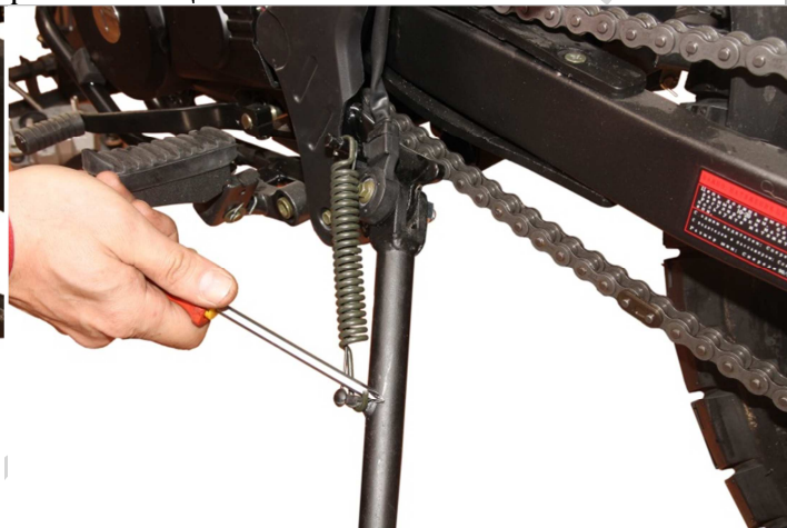
3.11.8. С помощью отвертки крепим пружину на точке крепления, расположенной на боковом упоре.
