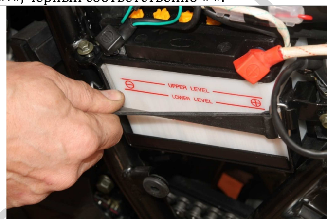
3.13.8. Аккуратно уложите провода в свободном промежутке между АКБ и кузовом. Зафиксируйте АКБ с помощью резинового фиксатора АКБ.
