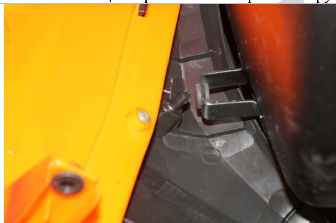
3.14.2. Боковой пластик фиксируется с помощью пластиковых фиксаторов в нескольких местах.
