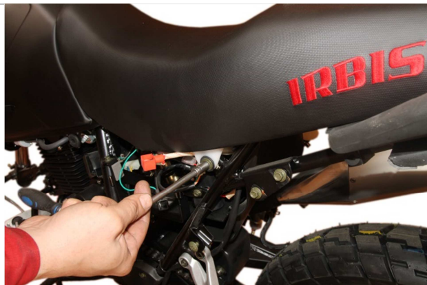
3.13.11. Закручиваем ранее выкрученные болты крепления сиденья.
