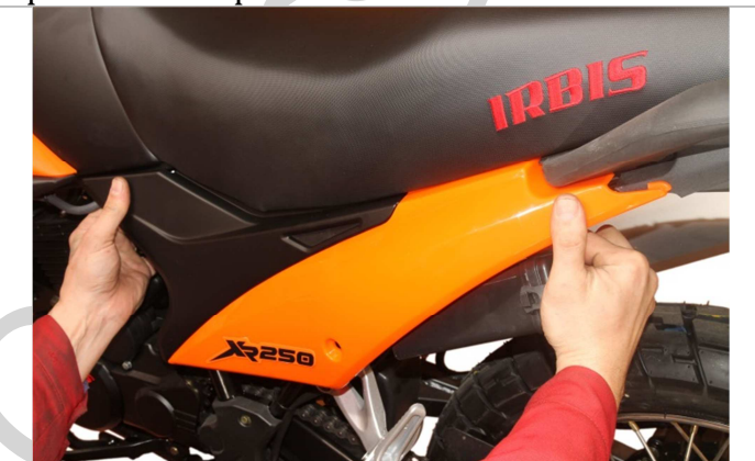
3.19.4. Фиксируем боковой пластик фиксаторами.
