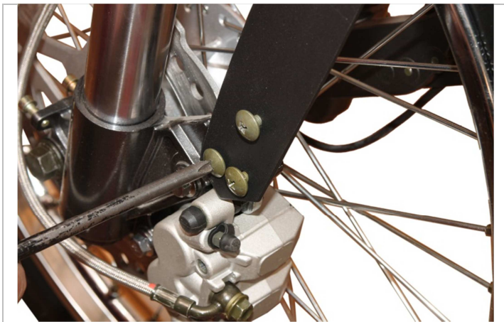
3.19.3. Фиксируем переднее крыло с левой и правой сторон ранее выкрученными винтами.
