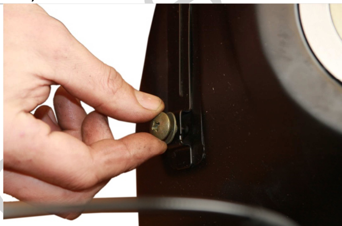
3.14.1. С помощью крестовой отвертки выкручиваем два винта крепления пластика бака.
