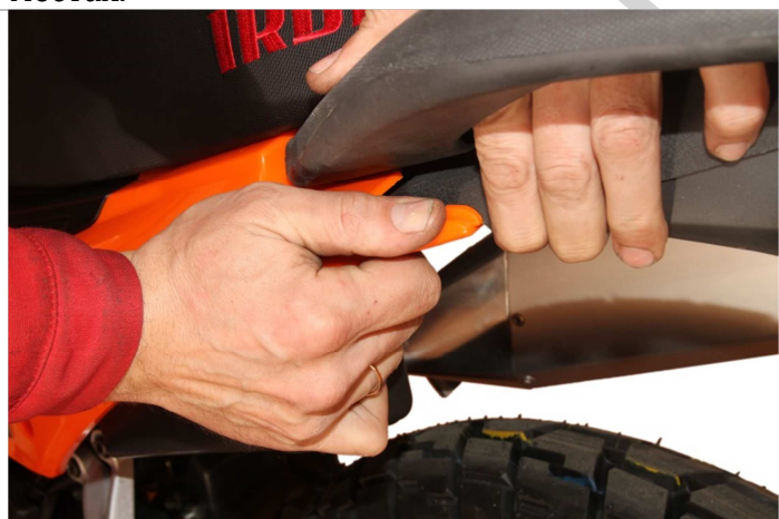
3.19.5. Соединяем боковой пластик с задним пластиком так, как указано на рисунке.
