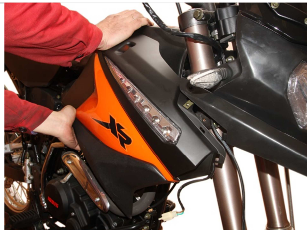
3.14.4. Устанавливаем пластик бака так, как указано на рисунке.
