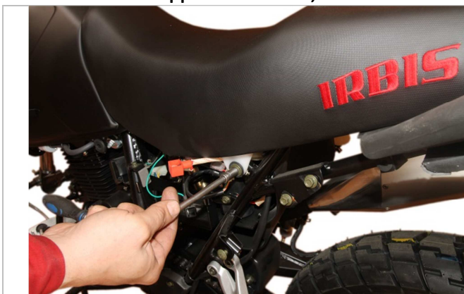
3.13.1. Снимаем переднее сиденье. Для этого откручиваем два болта его крепления с левой и правой сторон.
