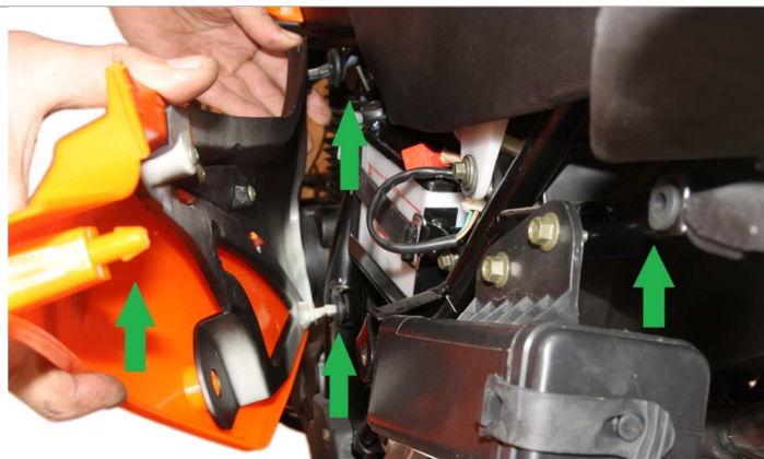
3.19.3. Устанавливаем боковой пластик. Внимание! Боковой пластик фиксируется с помощью пластиковых фиксаторов в трех местах.
