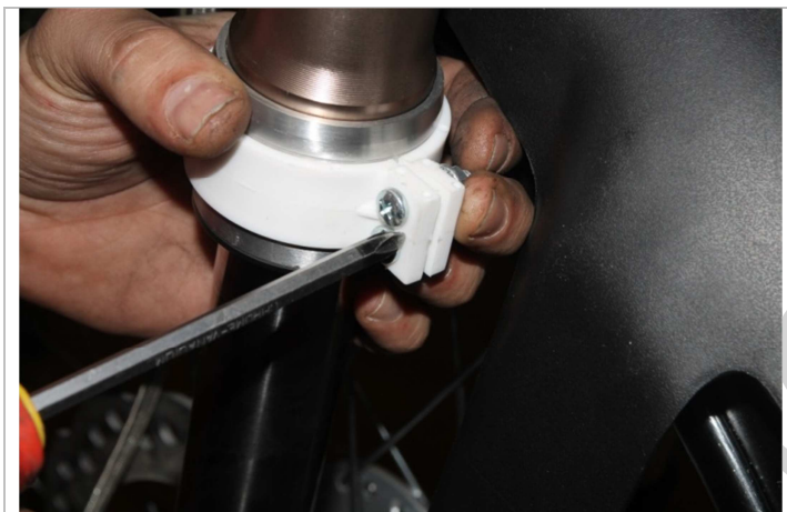
3.20.1. Откручиваем два винта крепления пластикового хомута амортизатора.
