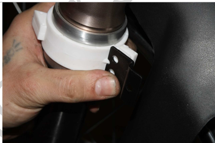
3.20.2. Устанавливаем кронштейн крепления катафота.
