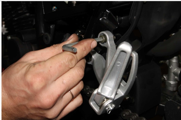
3.9.2. Устанавливаем подножку. Закручиваем подножку пассажира ранее выкрученными болтами.
