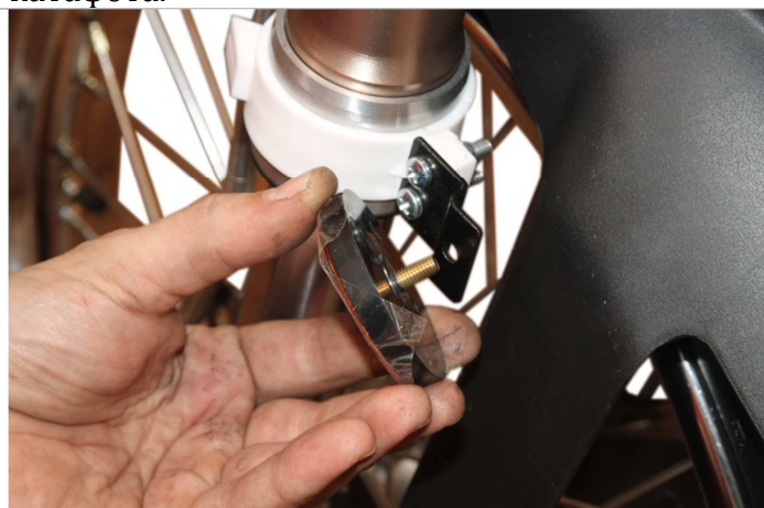
3.20.4. Устанавливаем катафот. Фиксируем его с помощью гайки М8 из набора крепежных элементов. С другой стороны мотоцикла устанавливаем катафот тем же способом.
