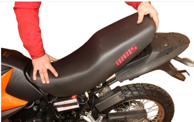
3.13.10. Для этого нажимаем на переднюю часть сиденья и подаем его вперед.
