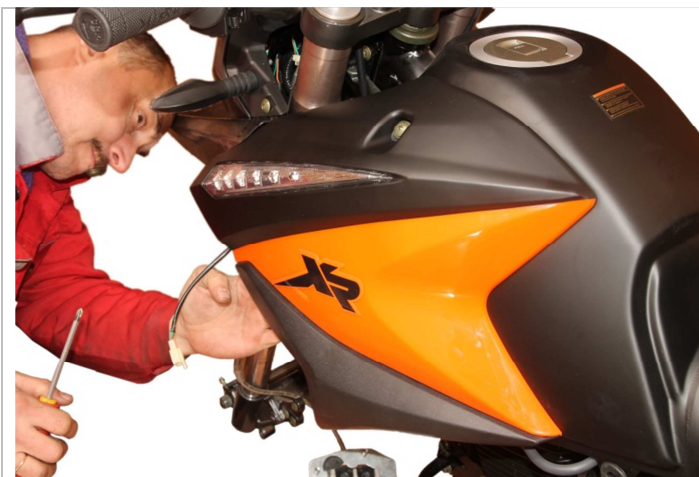
3.14.9. Фиксируем установленный пластик с помощью ранее выкрученного болта в нижней части бака (под пластиком бака).
