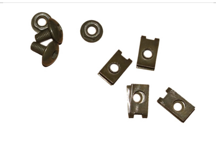
3.6.2. Для дальнейших действий потребуется: Металлические клипсы крепления пластика (4 шт.), болт М8 под шестигранник (2шт.), гайка для болта (2 шт.).
