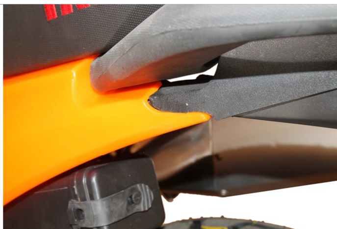
3.19.5. Соединяем боковой пластик с задним пластиком так, как указано на рисунке.
