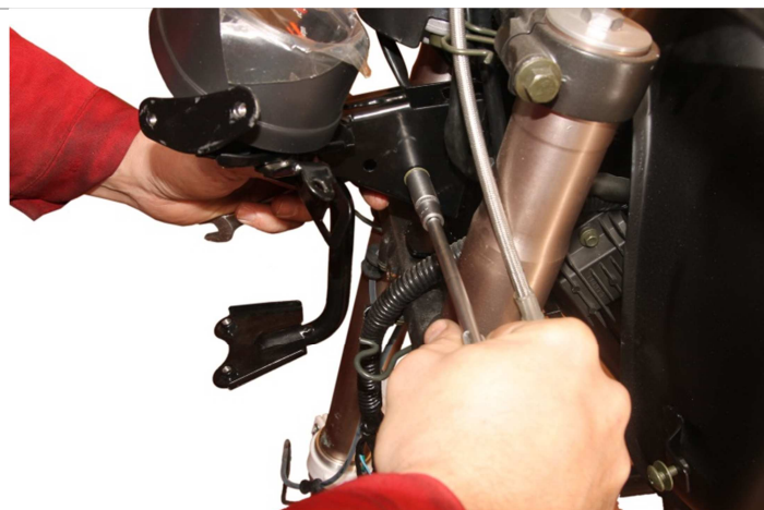
3.5.4. Затягиваем болты крепления.
