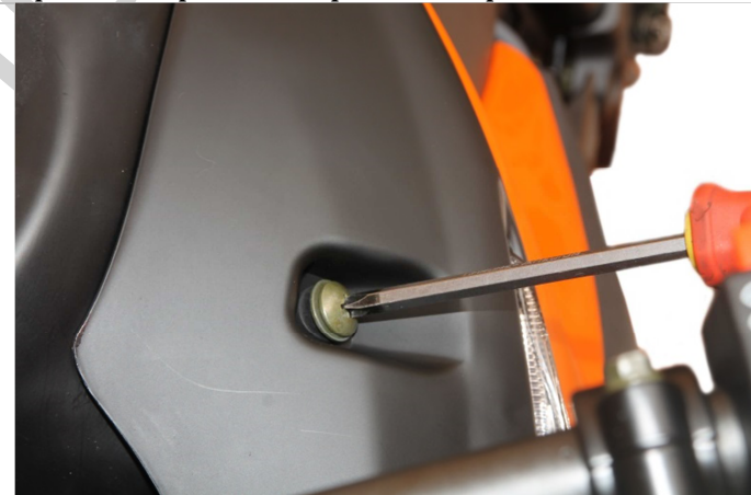
3.14.8. Фиксируем установленный пластик с помощью ранее выкрученного болта в верхней части бака.
