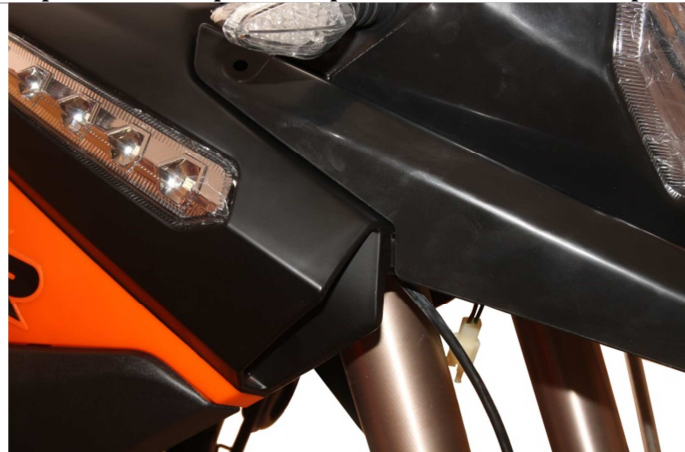
3.14.7. Стык пластика бака с «фальш» крылом должен выглядеть так, как указано на рисунке.
