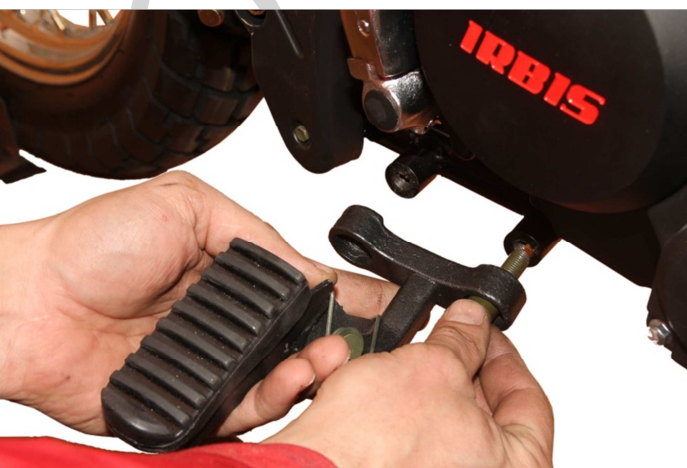
3.10.2. Устанавливаем подножку водителя и фиксируем ее болтами.
