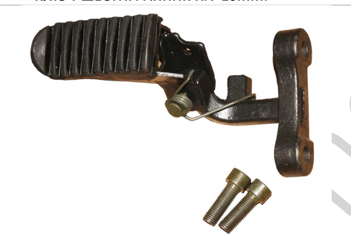
3.10.1. Для установки правой подножки водителя из комплекта крепежа необходим болт М10 под шестигранник (2 шт.).
