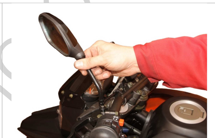
3.24.1. Вкрутите зеркала в штатные отверстия в блоках управления руля (с левой и правой сторон).
