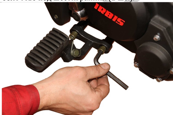
3.10.3. Затягиваем болты крепления.
