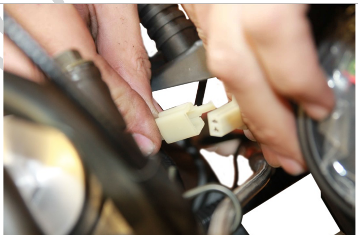
3.14.13. Подключаем разъем ходового огня, расположенного на пластике бака.
