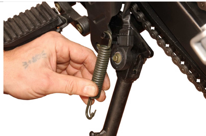
3.11.7. Устанавливаем пружину бокового упора. Для этого сначала закрепляем ее в верхней точке крепления, расположенной на раме мотоцикла.
