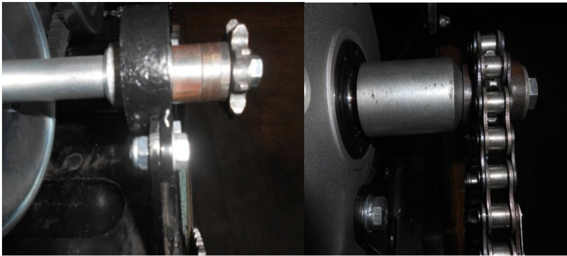
*Рис.7. Проверка натяжения цепи привода промежуточного вала*
