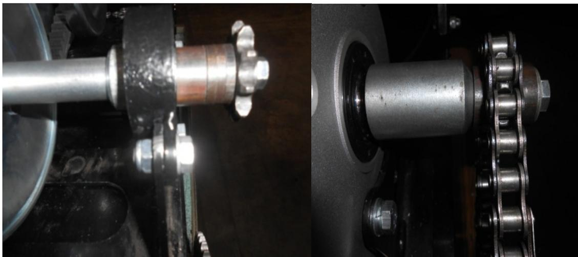
**Рис.7. Проверка натяжения цепи привода промежуточного вала**
