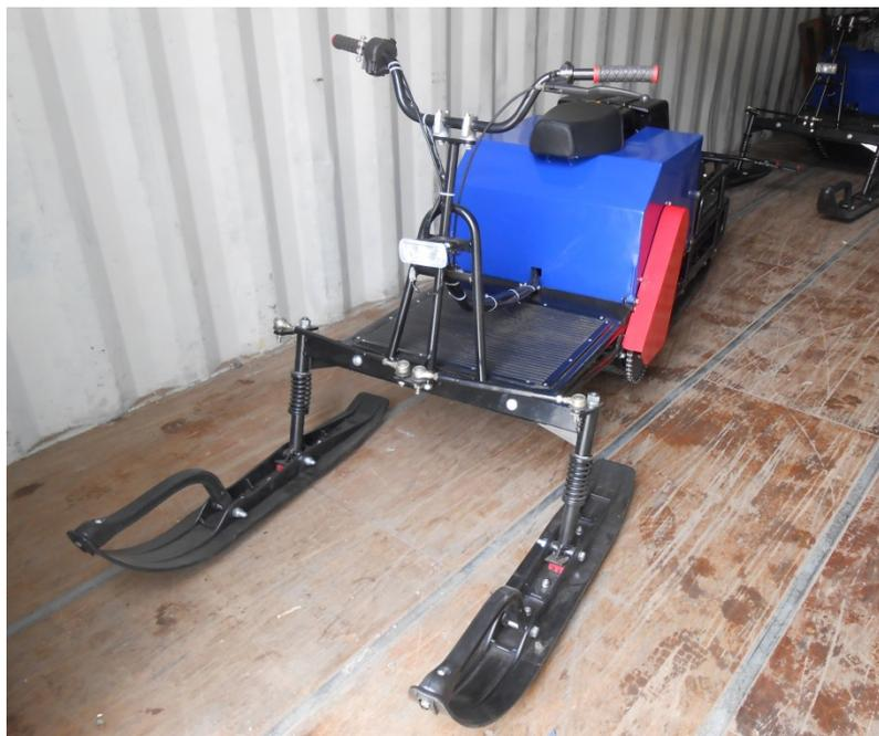
Рис. 3. Мотобуксировщик с лыжным модулем.
