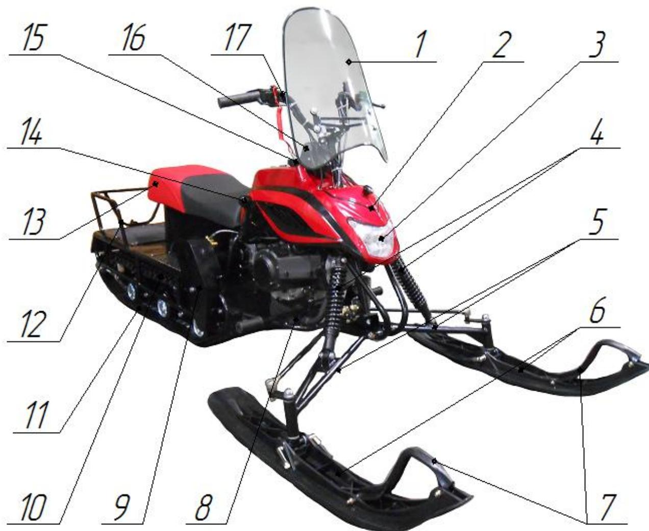
1. Ветровой щиток; 2. Пластик моторного блока; 3. Фара головного света; 4. Передние амортизаторы; 5. Рычаги передней подвески; 6. Лыжи; 7. Наконечник (ручка) лыжи; 8. Глушитель; 9. Защитная крышка приводной цепи; 10. Подножка; 11. Гусеница; 12. Багажник; 13. Сиденье; 14. Рычаг переключения режимов трансмиссии; 15. Замок зажигания; 16. Панель приборов; 17. Руль;
