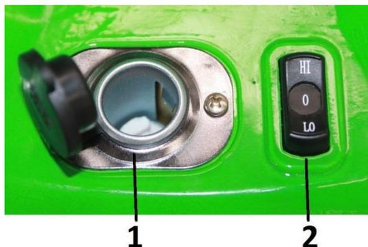
1. *Розетка для внешних приборов 12V:* Расположена на панели за бензобаком, предназначена для питания от сети 12В внешних устройств. Рабочее напряжение: 12В. Суммарный ток: 5 А. Максимальная суммарная мощность: 60 Вт. **Предназначена для слаботочных изделий!**
