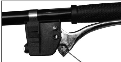
Рис. 9 Установка наконечника троса газа
