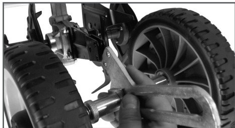
Рис. 6 Установка кронштейна колес
