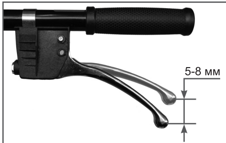
Рис. 11 Регулировка троса газа
