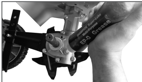
Рис. 24 Добавление смазки в корпус редуктора
