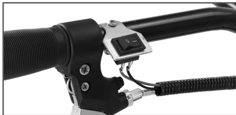
Рис. 13 Подключение проводов к выключателю зажигания
