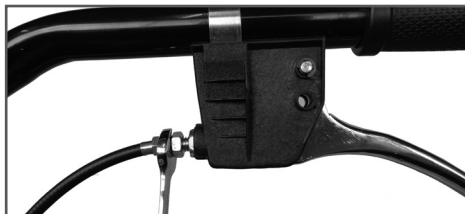
Рис. 10 Установка регулировочной муфты троса газа
