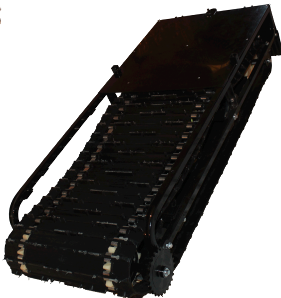
Рис. 7 Гусеничный движитель в транспортном положении неразборная модификация (со съёмной спинкой багажника)
