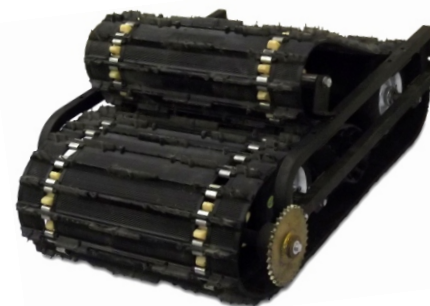
Рис. 6 Гусеничный движитель в транспортном положении разборная модификация
