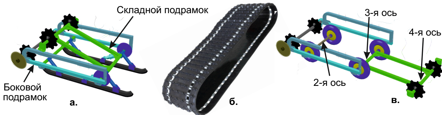
Рис. 8. Схема установки гусеницы на разборную модификацию
