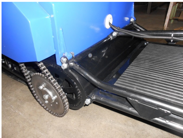
Рис. 6. Установка лыжного модуля.
