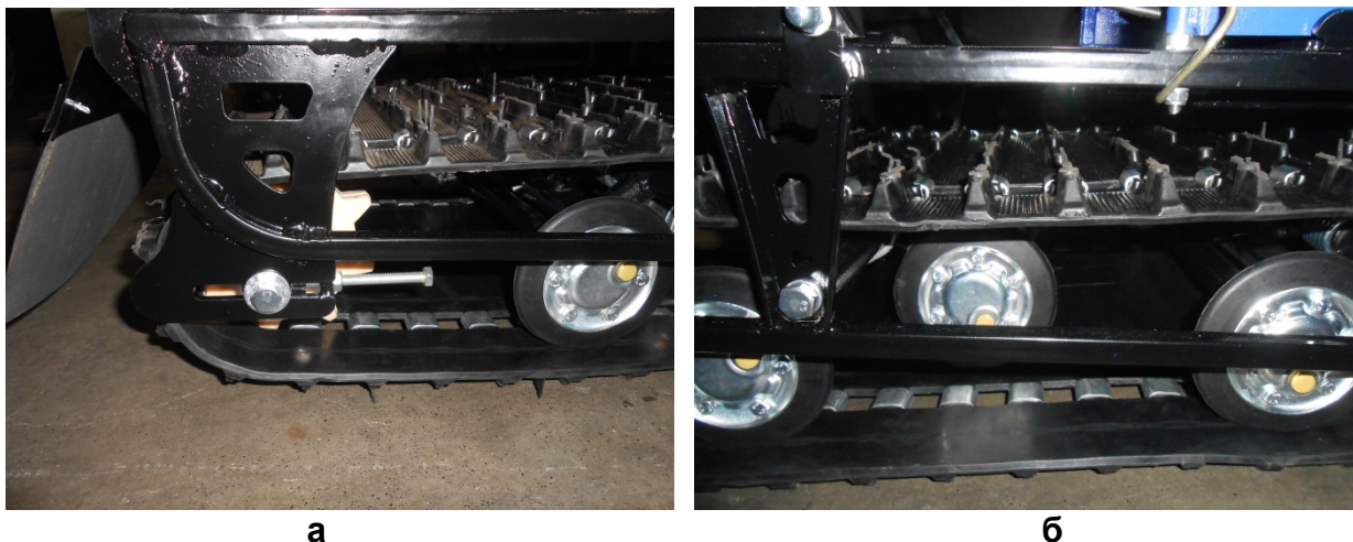
Рис. 8. Регулировка натяжения гусеницы
