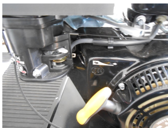
Рис. 7. Подключение органов управления.
