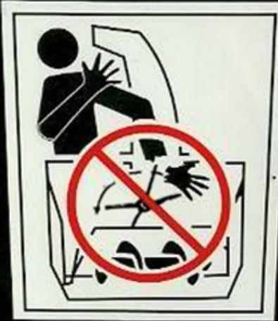
**Остановите двигатель перед прочисткой разгрузочного желоба!**
