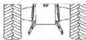
Согласно с инструкцией по обслуживанию, давление воздуха в задних и передних шинах трактора должно быть одинаковым (особенно в задних шинах)! Нижние тяги навесной системы трактора перед присоединением машины должны быть переставлены в нижнее положение на одинаковую высоту (минимальная высота шарниров над землей 200 мм). Тяги установленные на одинаковой высоте от земли, облегчают присоединение картофелесажалки к трактору.
