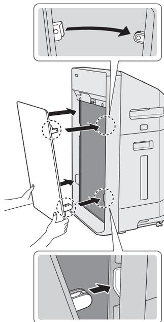
※必ずフロントパネルを取り付けて使用してください。
