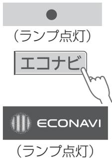
「エコナビ」運転とは、「パトロール運転」と「学習運転」を組み合わせ消費電力を抑える自動運転です。風量は自動制御されます。(P.18)
