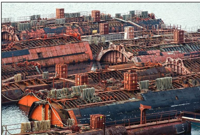
Трехотсечные реакторные блоки на длительном хранении
