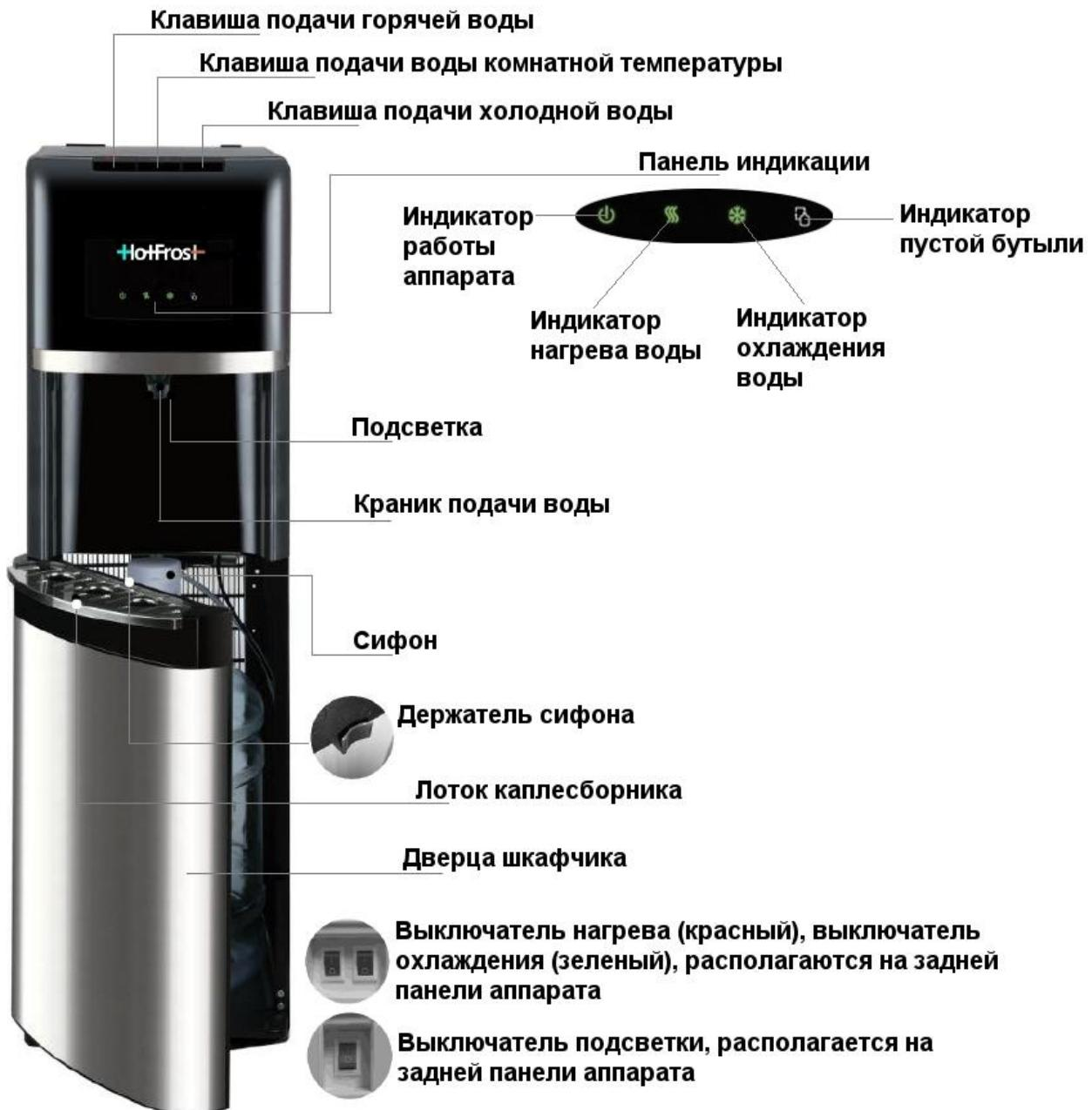
Рис.1 (а) Схема аппарата 35A (S,N)
