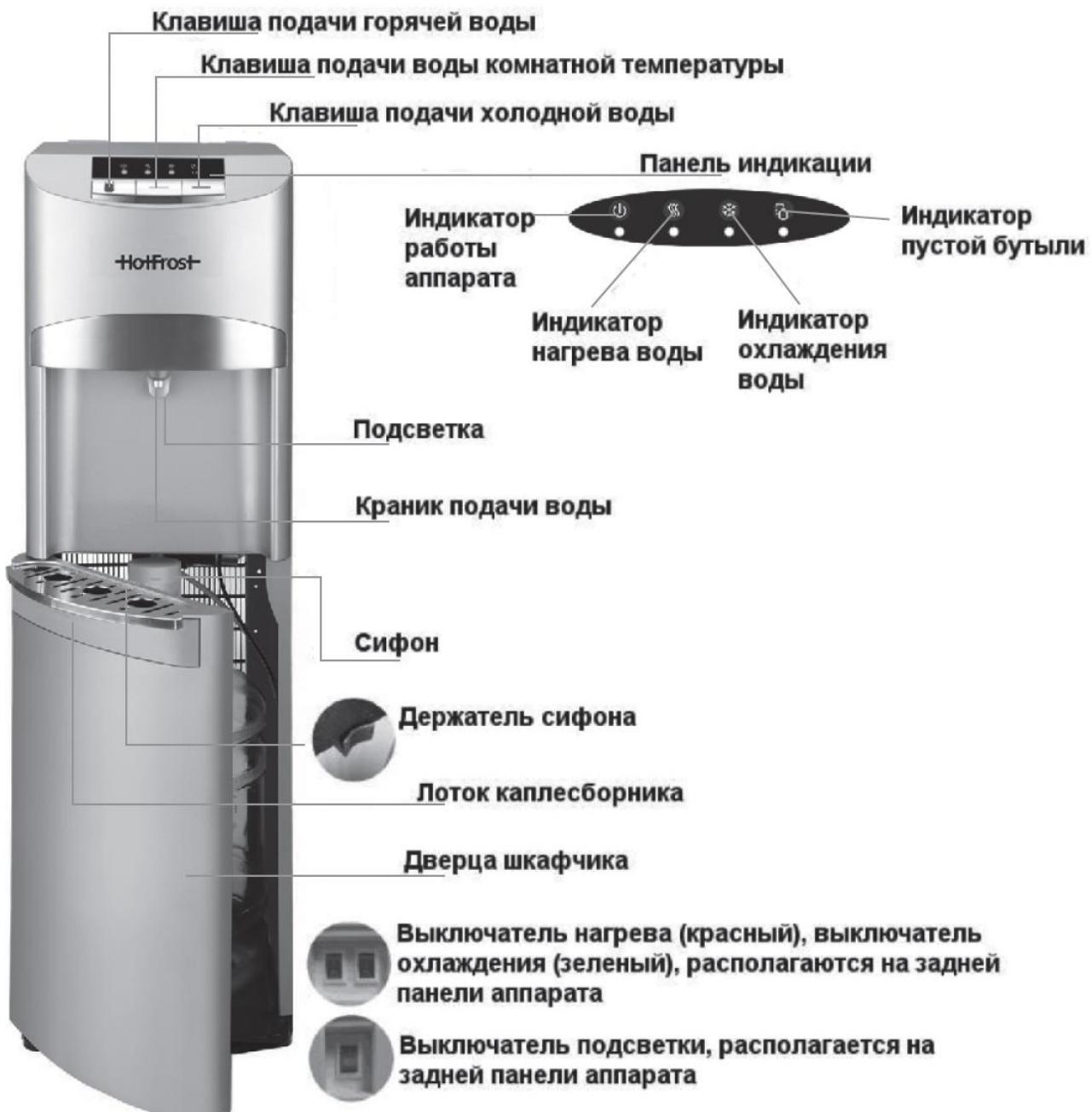
Рис.1 (б) Схема аппарата 35А (S,N)
