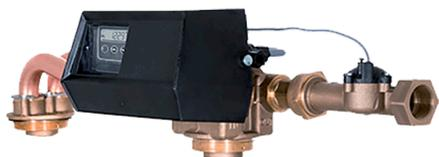
Клапан с корпусом из латуни с полностью регулируемым 5-цикловым управлением является эффективным и надежным решением для умягчения воды с корпусами диаметром до 24 дюймов.
