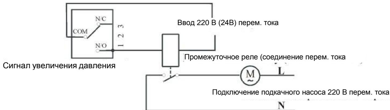
**Требование: источник переменного тока 220 В должен быть снабжен размыкающим выключателем**
