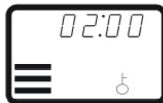
(Такая индикация отсутствует при отсчете по часам). Цветная полоска указывает на рабочий режим клапана. Время начала восстановления 02:00.
