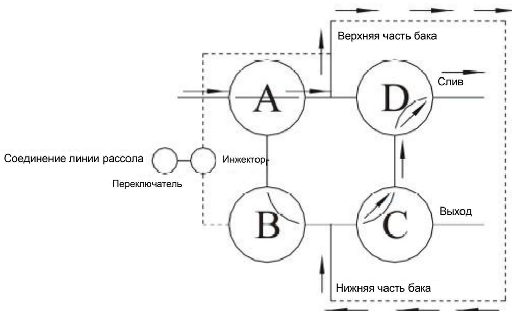
Сырая вода входит в трехходовой клапан А через вход и через верхнюю часть поступает в бак. Затем она проходит вниз через слои смолы, через трехходовые клапаны С и D, и, наконец, вытекает из слива.
