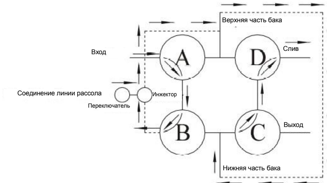
Сырая вода входит в трехходовой клапан А через вход, затем через трехходовой клапан В поступает в инжектор и быстро вытекает из сопла инжектора, что создает отрицательное давление. В этот момент электрический шаровой клапан открыт, поэтому рассол из бака рассола подсасывается через соединение линии рассола в верхнюю часть бака. Рассол проходит вниз через слои смолы, через трехходовые клапаны С и D, и, наконец, вытекает из слива.
