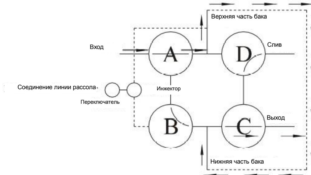
Сырая вода входит через вход в трехходовой клапан А и через верхнюю часть поступает в бак. Затем вода проходит вниз сквозь слои смолы (она смягчается, а при наличии угольного слоя также очищается). После смягчения воды она проходит через трехходовой клапан С и поступает на выход.
