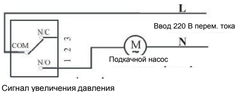
**Подключение подкачного насоса с помощью промежуточного реле (ток > 5 А)**
