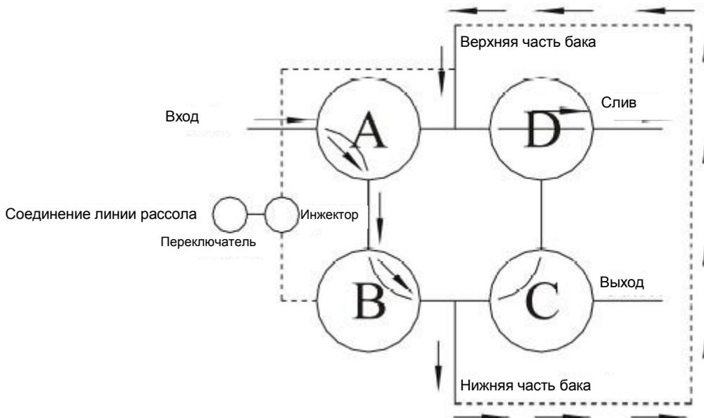
Сырая вода входит через вход в трехходовой клапан А, затем через трехходовой клапан В поступает в нижнюю часть бака, проходит внизу вверх через слои смолы в верхнюю часть бака и через трехходовой клапан D поступает на слив.
