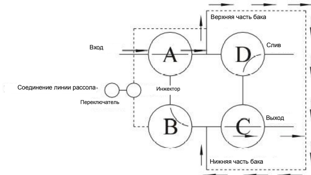
Сырая вода входит через вход в трехходовой клапан А и через верхнюю часть поступает в бак. Затем вода проходит вниз сквозь слои смолы (она смягчается, а при наличии угольного слоя также очищается). После смягчения воды она проходит через трехходовой клапан С и поступает на выход.
