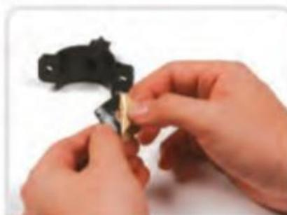
**2** Снимите защитную пленку с резинового уплотнителя
