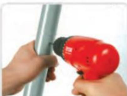
**1** Просверлите отверстие диаметром 7 мм
