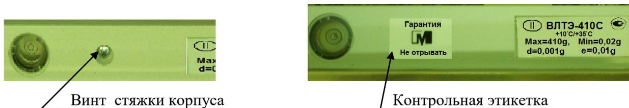
Рисунок 2 - Схема пломбирования от несанкционированного доступа
