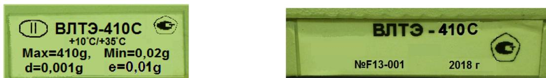
Рисунок 4 – Маркировка весов
