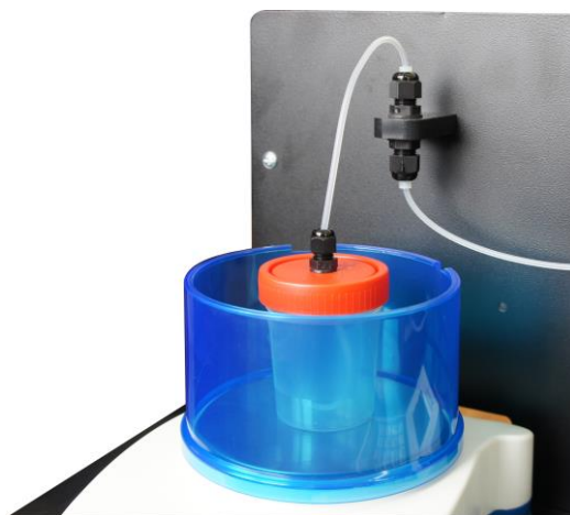
Рисунок 11 Установка стакана с раствором титранта и короткой трубки насоса
