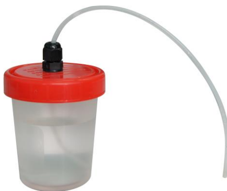
Рисунок 10 Стакан с титрантом и трубкой
