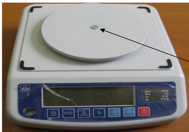
Рисунок 2 - Схема пломбирования от несанкционированного доступа и обозначение места для нанесения отиска клейма.
