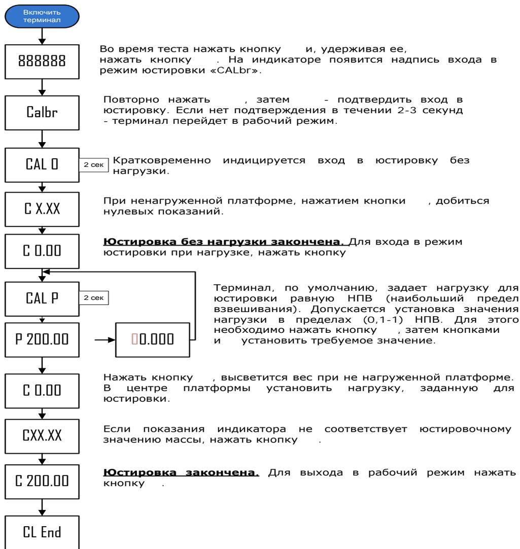
Рис. 17.1. Порядок проведения юстировки
