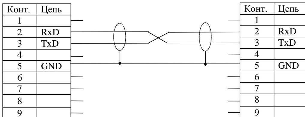
Рис. 10.1 - Кабель подключения к весам с вилкой
