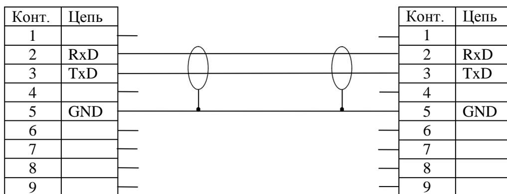
Рис. 10.2 - Кабель подключения к весам с розеткой
