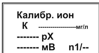
В верхней строке отобразится обозначение текущего режима «Калибр. ион», строкой ниже – символ определяемого иона, в данном случае иона калия «K». Вместо прочерков будут прописаны значения массовой концентрации (в единицах мг/л), рХ и ЭДС для первой точки градуировки (n1) и в правом нижнем углу после дробной черты - количество точек градуировки (N), сохранённые в памяти анализатора после последней градуировки.
