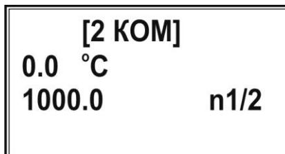
В двух нижних строчках отобразятся координаты текущей точки градуировки: значения температуры (в °C) и сопротивления (в Ом). В правом нижнем углу дисплея отобразится номер текущей точки градуировки (например, n1) и после дробной черты – число точек градуировки.
