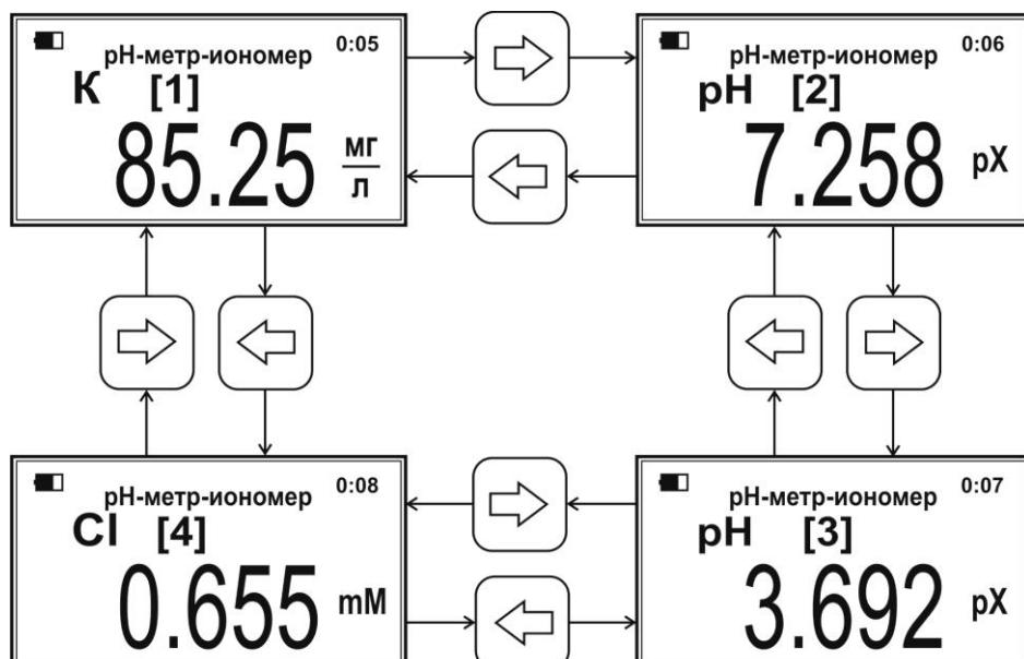
**ПРИМЕЧАНИЕ** Если к одному или нескольким каналам подключены pH-электроды, то для выполнения измерений pH с термокомпенсацией предварительно установите режим ввода температуры в соответствии с п. 2.4.4.1. При нажатии кнопки «ТК» во время измерения pH на одном из каналов, термокомпенсация будет проводиться для всех каналов, которым присвоен ион «pH».
