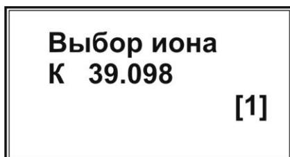
Перебирая номера каналов кнопками «←» и «→», выберите с помощью кнопок «<» и «>» требуемые для каждого из каналов ионы из введённых в память прибора.
