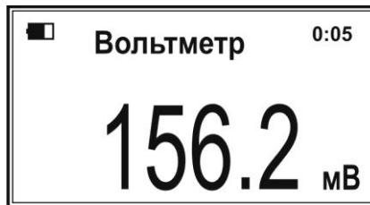
В первой строке сверху появится символ состояния заряда аккумулятора и показание таймера. Во второй строке отобразится название текущего режима измерения «Вольтметр». В нижней строке крупным шрифтом отобразится результат измерения ЭДС электродной системы.
