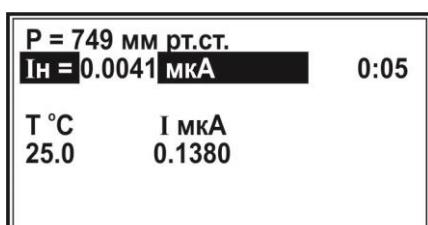
После установления стабильного значения силы тока (изменение не превышает ±1 % от текущего значения в минуту) нажимают кнопку «ВВОД». Значение силы тока для бескислородной среды зафиксируется во второй строке:
