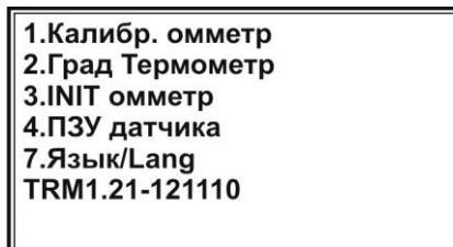
Нажмите кнопку «**2**», обозначающую номер пункта «**Град Термометр**». Анализатор перейдёт в состояние градуировки температурного датчика и на дисплее отобразится следующая информация:
