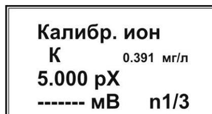
При этом анализатор автоматически рассчитает и отобразит на дисплее соответствующее значение массовой концентрации иона калия.
