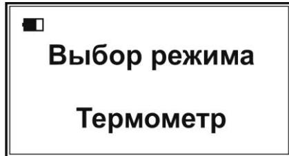
Подключите температурный датчик, погрузите его в анализируемый раствор и нажмите кнопку «ИЗМ». Прибор перейдёт в состояние измерения температуры и на дисплее появится надпись:
