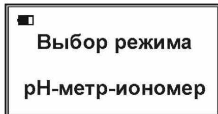
В левом верхнем углу дисплея отобразится символ состояния аккумулятора. В нижней строке отобразится название текущего режима «рН-метр-иономер».
