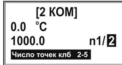
Нажмите на клавиатуре кнопку с цифрой, соответствующей числу точек градуировки, например «3». На дисплее зафиксируется введённое число точек градуировки:
