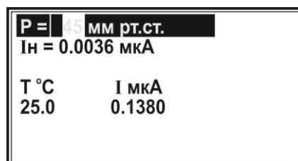
Набирают на клавиатуре число, соответствующее показанию давления барометра в мм рт.ст., например, «749»:
