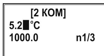
При ошибочном вводе нажмите кнопку «**←→**» (каждое нажатие удаляет последнюю набранную цифру). Нажмите кнопку «**ВВОД**». Набранное значение зафиксируется во второй строке:
