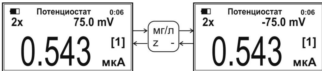
При выводе результата измерения тока анализатор автоматически выбирает оптимальный номер поддиапазона измерения токов:
