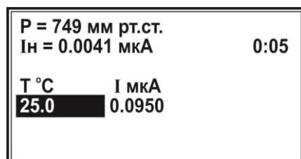
После установления стабильного значения силы тока (изменение не превышает  $\pm 1$  % от текущего значения в минуту) нажимают кнопку «ВВОД». Значение силы тока для воды, насыщенной кислородом воздуха при температуре  $+(25,0 \pm 0,2)$  °C зафиксируется в нижней строке:
