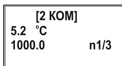
Нажмите кнопку «**ИЗМ**». В нижней строке отобразится измеряемое значение сопротивления. После установления стабильного значения сопротивления (изменение не более  $\pm 1\%$  от измеряемого значения), например, «1039», нажмите кнопку «**ВВОД**». Измеренное значение зафиксируется в нижней строке:
