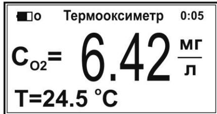
В первой строке сверху появятся символ состояния заряда аккумулятора, название текущего режима измерения «**Термооксиметр**» и показание таймера. Во второй строке крупным шрифтом отобразится результат измерения массовой концентрации растворённого кислорода. В нижней строке отобразится результат измерения температуры анализируемой среды.
