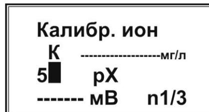
**ПРИМЕЧАНИЕ** Чтобы удалить набранную цифру, нажмите кнопку «←». Каждое нажатие удаляет последнюю набранную цифру. Данная операция применяется в случае необходимости исправлений при вводе численных значений (здесь и далее).
