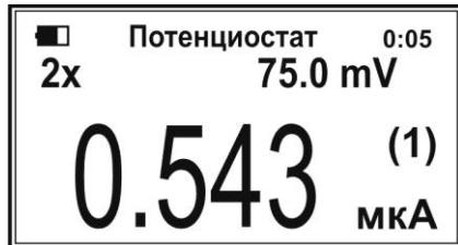
Для изменения полярности подаваемого на электродную систему напряжения нажмите кнопку « $\leftarrow\rightarrow$ ». Например, если было установлено значение «75 mV», то при нажатии кнопки « $\leftarrow\rightarrow$ » установится значение «-75 mV». Для возврата к прежней полярности нажмите кнопку « $\leftarrow\rightarrow$ » еще раз:
