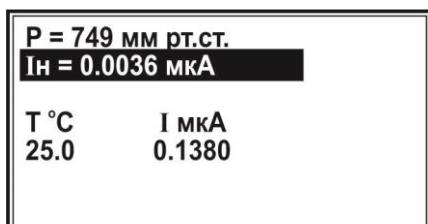
Устанавливают в термостате температуру +25,0 °C. Включают подачу азота и насыщают им воду не менее 30 минут. При этом нажимают кнопку «ИЗМ» и выполняют измерение значения силы тока в бескислородной среде при температуре +(25,0 ± 0,2) °C (первая градуировочная точка). В правом верхнем углу дисплея появится показание таймера, отсчитывающего время с начала измерения, а в выделенной строке отобразится измеряемое значение силы тока:
