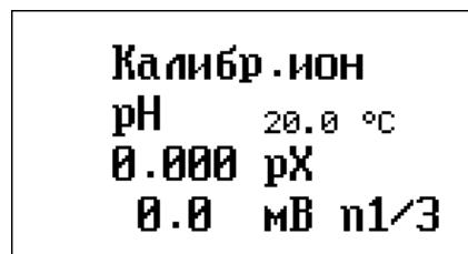
Пользуясь таблицей А.1 ГОСТ 8.134 определите значение pH буферного раствора при измеренной температуре. В данном случае, при 20,0 °C, значение pH буферного раствора, воспроизводящего при 25 °C значение pH 9,18, составляет 9,225.
