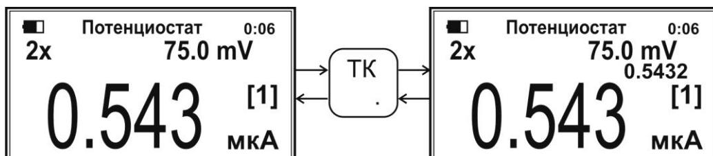
Для увеличения скорости измерения тока (увеличения числа измерений тока с 2 до 5 раз в секунду) нажмите кнопку «Ф2». При этом на дисплее под обозначением типа электродной системы отобразится надпись «FAST». Для возврата к обычной скорости измерения тока повторно нажмите кнопку «Ф2»:
