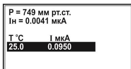
Вводят точное значение температуры воды, измеренное ртутным термометром, если оно отличается от установленного значения температуры  $+25,0$  °C. Для этого нажимают кнопку «ЧИСЛ». В месте ввода значения температуры появится указатель в виде мигающего прямоугольника:
