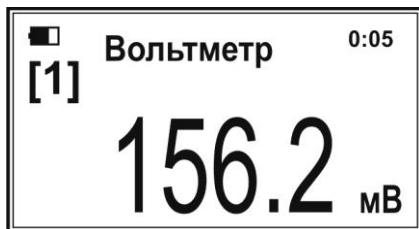
В квадратных скобках под символом состояния аккумулятора отобразится номер текущего канала «[1]».
