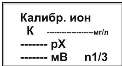
**ПРИМЕЧАНИЕ** Анализатор позволяет вводить от двух до пяти точек градуировки по каждому иону. При попытке ввода большего или меньшего числа, анализатор подаст короткий звуковой сигнал, не фиксируя ошибочно введённое значение.
