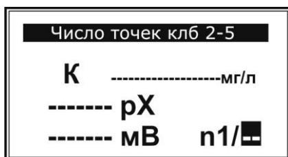
Мигающий прямоугольник указывает на готовность прибора к вводу нового значения N. Введите число точек градуировки (от 2 до 5) нажатием кнопки с соответствующей цифрой, например «3» или выберите нужную цифру, перебирая цифры от 2 до 5 с помощью кнопок «←» и «→», и нажмите кнопку «ВВОД». Выбранное число точек градуировки зафиксируется в правом нижнем углу дисплея:
