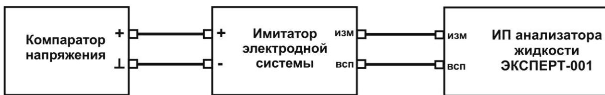
**Рисунок А.4** Схема установки для определения дополнительной абсолютной погрешности измерений pH, связанной с изменением сопротивления измерительного и вспомогательного электродов
