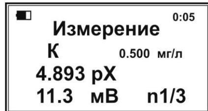
После того, как значение ЭДС стабилизируется (дрейф значения ЭДС не более  $\pm 1,5$  мВ/мин, а для модификаций «**ЭКСПЕРТ-001-1**» и «**ЭКСПЕРТ-001-2**» при использовании высокостабильных электродов – в соответствии с их документацией), нажмите кнопку «**ВВОД**». Появится запрос:
