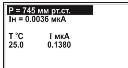
Вводят актуальное на момент измерений значение атмосферного давления в мм рт. ст. Для этого с помощью кнопок «←» и «→» выделяют верхнюю строчку (если она не была выделена) и нажимают кнопку «ЧИСЛ». В месте ввода значения давления появится указатель в виде мигающего прямоугольника:
