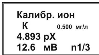
Введите значения ЭДС электродной системы для каждой градуировочной точки, перемещаясь между ними с помощью кнопок «<>» и «>>». После окончания ввода градуировок нажмите кнопку «**ОТМ**».
