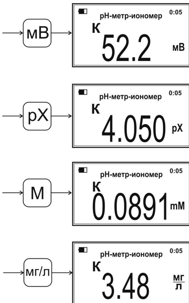
Стабилизация показаний происходит примерно через 2-3 минуты. Для более точной оценки стабилизации показаний выберите единицы измерения «**мВ**». Результат изменения фиксируют, когда амплитуда изменения ЭДС не превышает  $\pm 1,5$  мВ/мин для всех модификаций анализаторов при использовании стандартных электродных систем, а для модификаций «**ЭКСПЕРТ-001-1**» и «**ЭКСПЕРТ-001-2**» при использовании высокостабильных электродов – в соответствии с их документацией.
