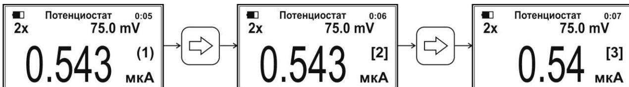
Для возврата к автоматическому выбору номера оптимального поддиапазона измерений тока нажмите кнопку «ИЗМ»:
