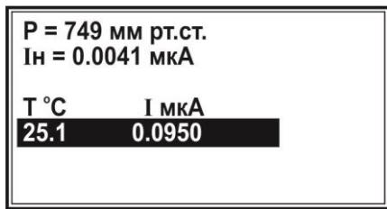
После окончания градуировки нажимают кнопку «**ОТМ**» два раза для перехода в режим работы «**Термооксиметр**».
