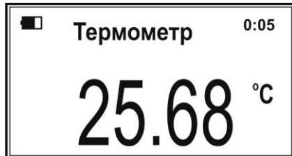
В первой строке сверху появится символ состояния заряда аккумулятора и показание таймера. Во второй строке отобразится название текущего режима измерения «Термометр». В нижней строке крупным шрифтом отобразится результат измерения температуры.
