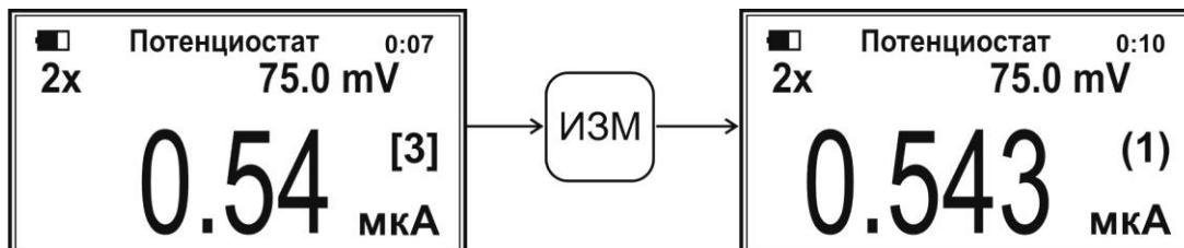
Для просмотра значения тока с большим числом значащих цифр вне зависимости от выбранного поддиапазона измерения токов нажмите кнопку «ТК». Точное значение отобразится мелким шрифтом над основным показанием тока. При повторном нажатии кнопки «ТК» точное значение тока исчезнет:
