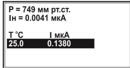
Отключают подачу азота, подсоединяют и включают микрокомпрессор и насыщают с его помощью воду атмосферным воздухом не менее 30 минут. При этом нажимают кнопку «ИЗМ» и выполняют измерение значения силы тока в дистиллированной воде, насыщенной кислородом воздуха при температуре  $+(25,0 \pm 0,2)$  °C (вторая градуировочная точка). В правом верхнем углу дисплея отобразится показание таймера, отсчитывающего время с начала измерения, а в выделенной строке отобразится измеряемое значение силы тока:
