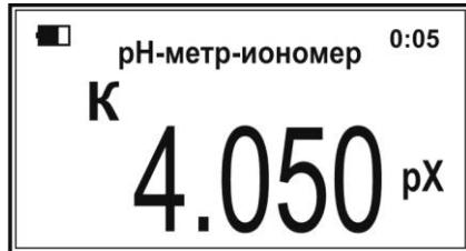
В первой строке сверху появится символ состояния заряда аккумулятора и показание таймера. Во второй строке отобразится название текущего режима измерения «**pH-метр-ионометр**». В третьей - определяемый ион, выбранный пользователем (в данном случае калий). В нижней строке – результат измерения.
