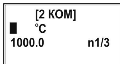
Наберите на клавиатуре число, соответствующее точному значению температуры воды в терmostате в  $^\circ\text{C}$ , например «5,2»:
