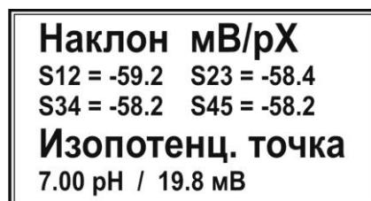
где S12, S23, S34 и S45 – значения наклона (крутизны) электродной функции на участке между первой и второй, второй и третьей, третьей и четвертой и четвертой и пятой градуировочными точками, соответственно.
