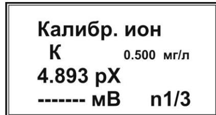
При этом анализатор автоматически рассчитает и отобразит на дисплее соответствующее значение рХ.
