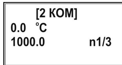
Установите температуру воды в терmostате в начале диапазона измерения температур, например  $+(5 \pm 0,5)^\circ\text{C}$ . Погрузите в воду температурный датчик и ртутный термометр. Включите перемешивающее устройство. Убедитесь, что выбрана первая точка градуировки **n1**. В противном случае перейдите к первой точке градуировки последовательными нажатиями кнопки «**▷**».
