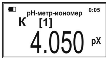
В первой строке сверху появится символ состояния заряда аккумулятора и показание таймера. Во второй строке отобразится название текущего режима измерения «**pH-метр-иономер**». В третьей – определяемый ион, выбранный пользователем для данного канала и в квадратных скобках – номер текущего канала. В нижней строке – результат измерения.
