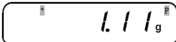
▫ Дальнейшие вариации нагрузки не изменяют показание. Для окончания данного измерения нажмите клавишу **POWER**. Показание обнулится и вновь высветится указатель **STAND-BY** – исходное состояние для следующего измерения пиковой нагрузки:
