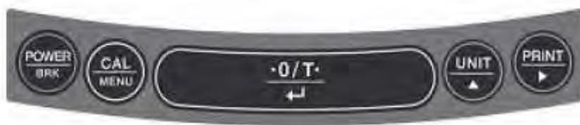
Функции клавиш, см. Табл. 2, подразделяются на две основные группы в зависимости от того, в каком рабочем режиме находятся весы в данный момент: взвешивание (на подписях к рисунку они обозначены в числителе) или настройка (в знаменателе). Кроме того, влияет (не всегда) время нажатия клавиши: кратковременное или длительное в течение ~ 3 сек.
