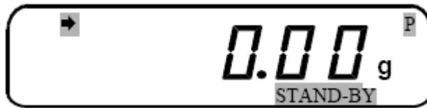
▫ Нажмите клавишу **PRINT**. Указатель **STAND-BY** выключится, и начнет действовать функция измерения пиковой нагрузки.
