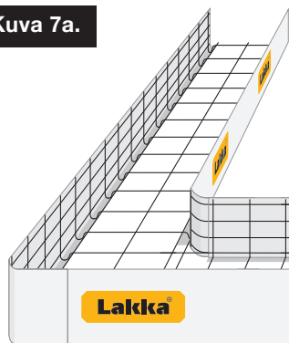
Luiskalla toteutettu porrastus.
