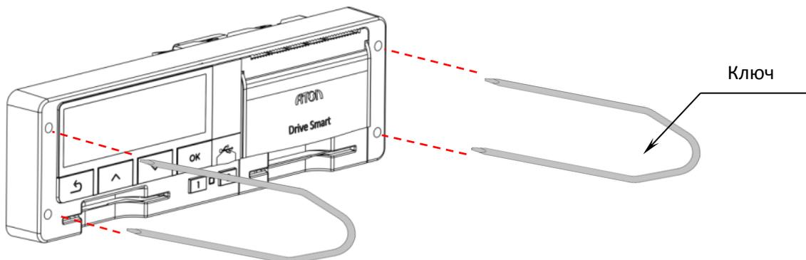
Рисунок 1. Извлечение тахографа
