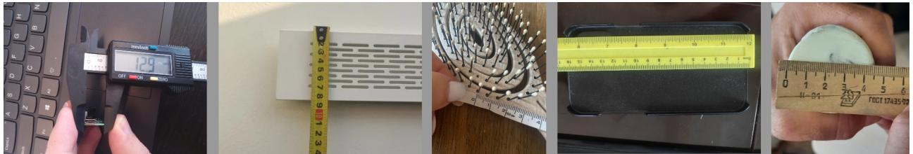
Кто-то измеряет портновским сантиметром, кто-то пластмассовой канцелярской линейкой, кто-то строительной рулеткой. И тогда «комедия» легко превращается в «драму», когда в результате две детали не лезут одна в другую или наоборот вываливаются и приходится все пересчитывать и перепечатывать.
