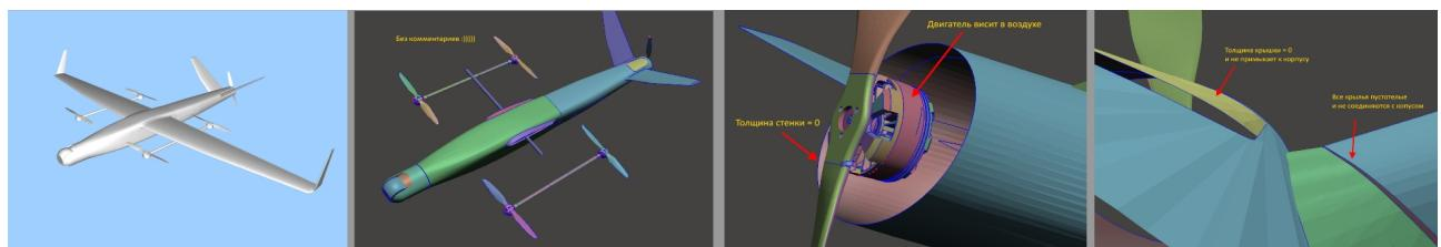
Все стенки нулевой толщины, крылья не соединяются с корпусом, двигатель висит в воздухе, штанги не соединяются между собой и тоже висят в воздухе. Ну чем не фильм ужаса!
