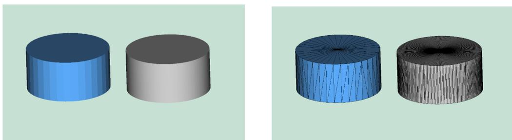
Легко понять, что в левом цилиндре боковая поверхность имеет  $72 +$  верх и низ  $36+36$ . Итого 144 треугольника. Правый цилиндр соответственно  $360+180+180=720$  треугольников. Видно, что на левом цилиндре сильно заметны грани.
