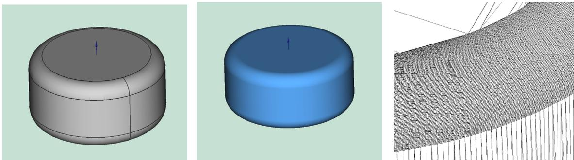
Левый рисунок — параметрическое представление, средний — тело STL, правый показывает крупно плотность сетки, которую строит программа для формирования скругления. Теперь для этой модели исходный STEP файл «весит» 11.4 кБ. STL файл имеет размер 6.4 Мб, а STEP, конвертированный из STL, получился 331 Мб (в 52 раза больше исходного STL)!!! А всего-то я добавил пару скруглений к простому цилиндру. Информация в обоих файлах одна и та же — те же треугольники и ничего больше!
