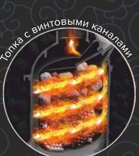
Форма топки с винтовыми каналами «закручивает» пламя, увеличивая КПД печи на 30%
