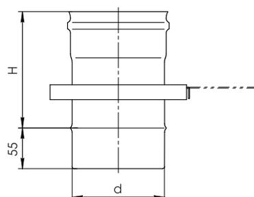
Предназначена для регулирования тяги в печи
