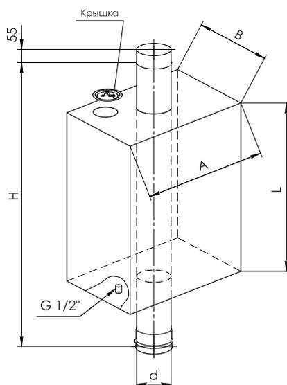
Предназначен для нагрева воды
