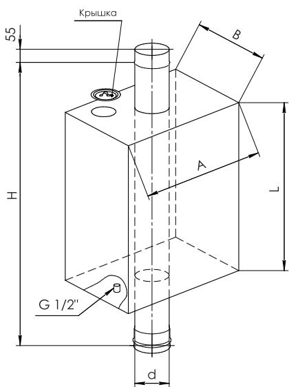
Предназначен для нагрева воды
