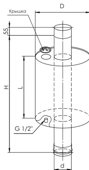
Предназначен для нагрева воды
